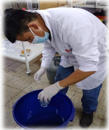
Se enjuagan los frascos con agua destilada y colocamos boca abajo para la toma de muestra.
