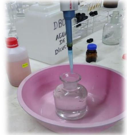
Se agrega 1ml sulfato de manganeso ( $MnSO_4$ ) a la muestra
