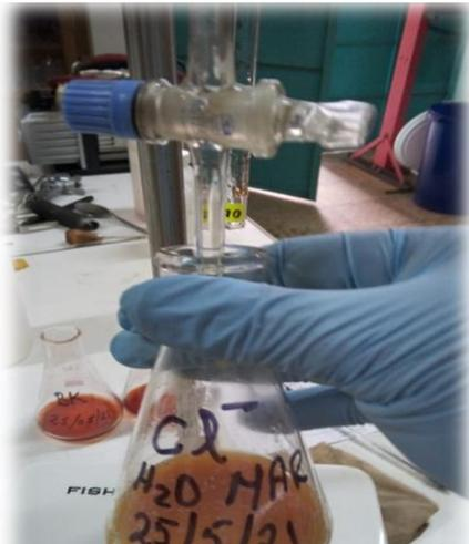
Se tituló con nitrato de plata ( $\text{AgNO}_3$ ) 0.1 N, el cual reaccionara con los cloruros presentes en la muestra.
