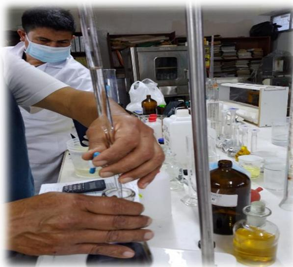
Se agregó 1ml de almidón. La cantidad de tiosulfato usado en la titulación es proporcional al yoduro, que es proporcional al  $O_2$  disuelto, y se calcula, pues, determinando la cantidad de tiosulfato utilizado.
