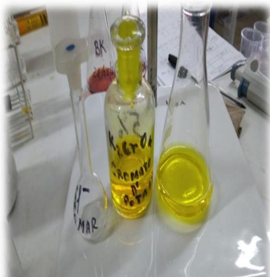
Se agregó el indicador, dicromato de potasio ( $K_2Cr_2O_7$ ) a la muestra.
