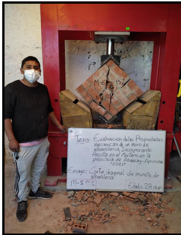
Figura 55. Falla diagonal y por los extremos falla por deslizamiento del mortero. por tensión
