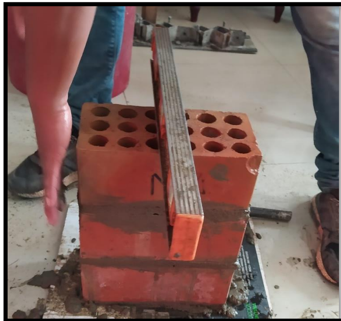
Figura 19. Elaboración de la pila de albañilería.
