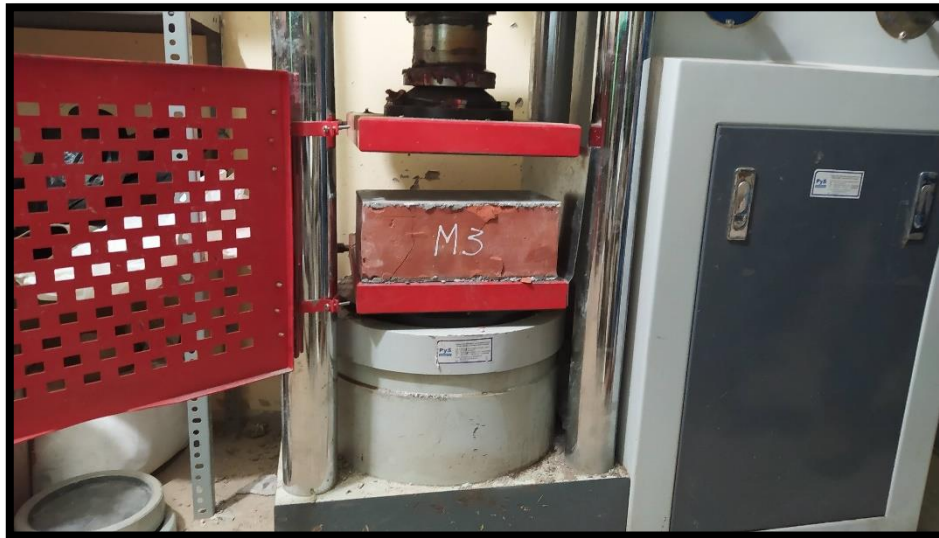
Figura 15. Ensayo de resistencia a la compresión de la unidad de albañilería.
