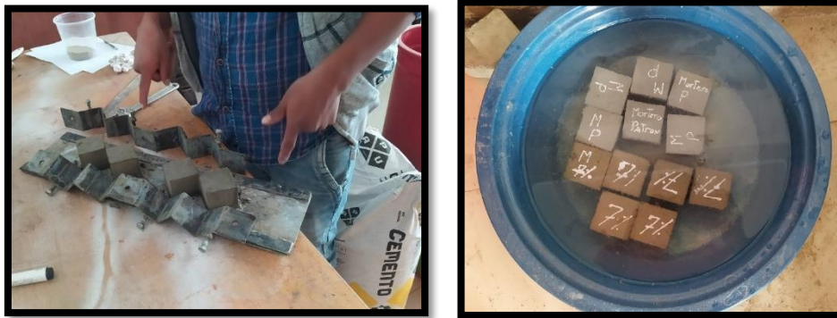
Figura 17.Desencofrado de los cubos de mortero y su respectivo curado.
