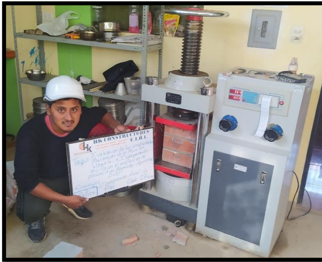
Figura 20. Ensayo de compresión axial en prismas de los ladrillos de albañilería a una edad de 28 días.
