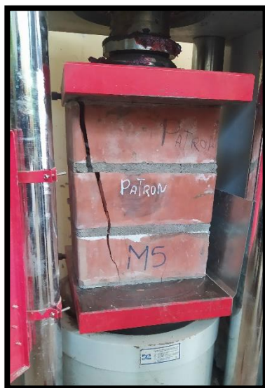
Figura 2. Ensayos de compresión axial de pilas.
