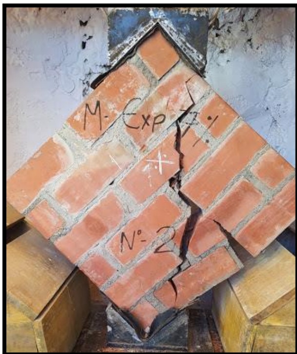
Figura 53. Falla por desplazamiento de las juntas del mortero y por tensión diagonal, obteniendo una falla mixta.
