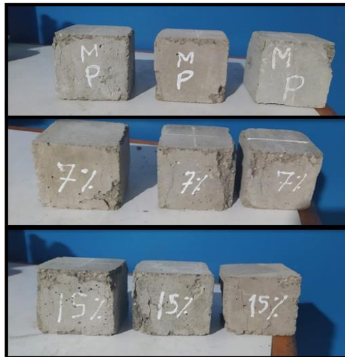
Figura 45. Muestras de mortero patrón y experimentales después de realizar el ensayo de compresión a una edad de 28 días.
