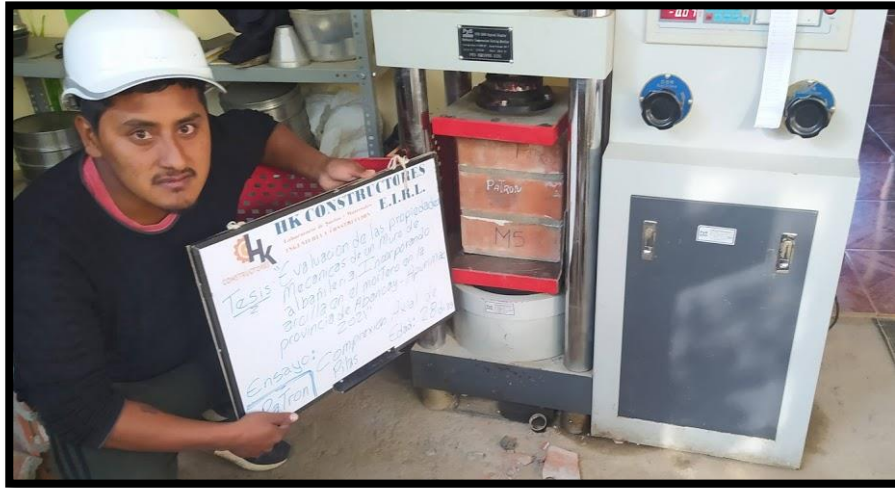
Figura 48. Ensayo de compresión axial a las pilas de albañilería muestra patrón.
