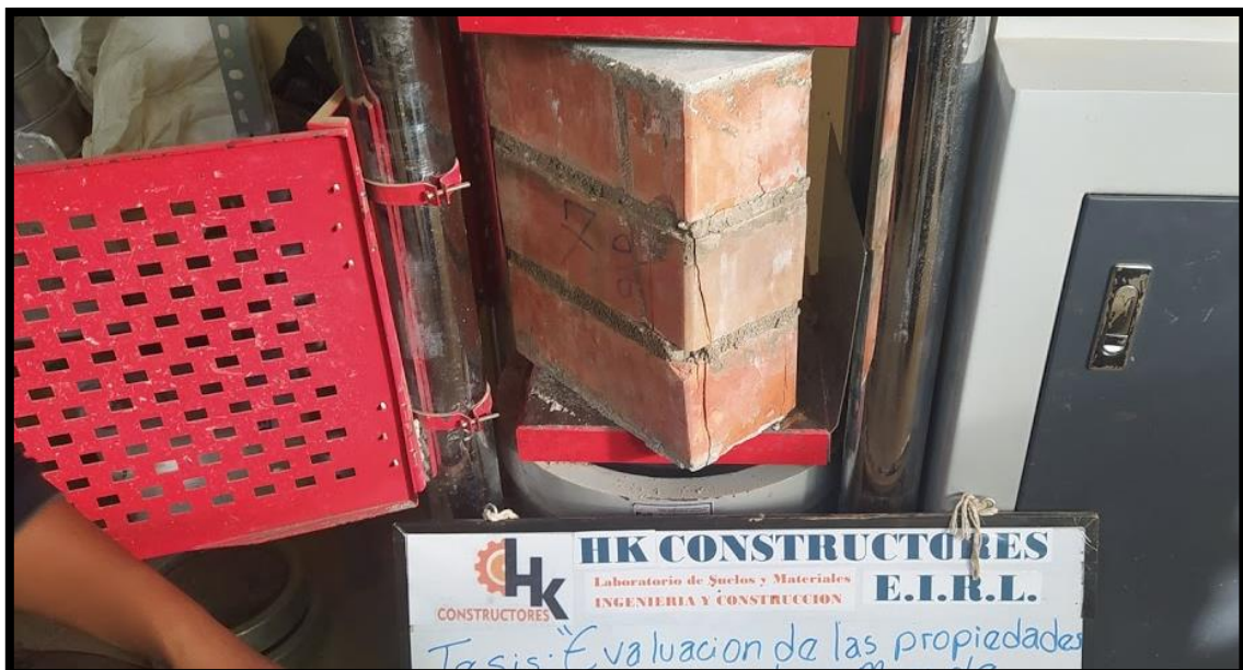
Figura 49. Ensayo de compresión axial a las pilas de albañilería muestra experimental (con 7% de arcilla).
