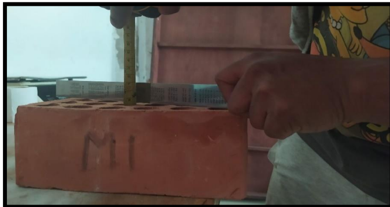
Figura 12. Ensayo de alabeo de la unidad de albañilería.
