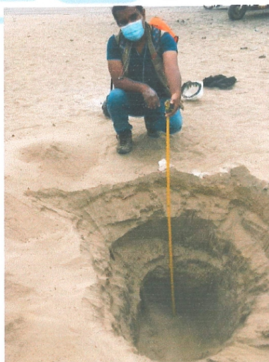
Foto N° 02.- Se observa la profundidad de la calicata C-02.
