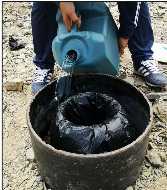
figura 40: vaciamos el agua dentro de los anillos para realizar los ensayos respectivos.
