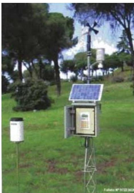
*Nota.* Pluviómetro de marca Geonica. Fuente:
