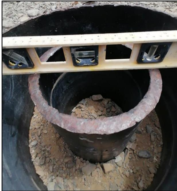
figura 39: Nivelación de los anillos de infiltración, ensayo realizado en la parte baja de la quebrada Solivin - San Jacinto.
