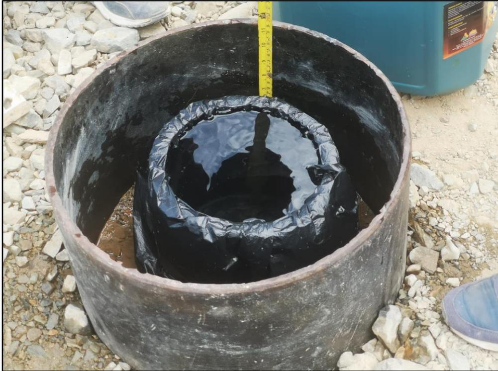
figura 41: medimos la altura del agua de acuerdo al tiempo de infiltración del agua hacia el terreno.
