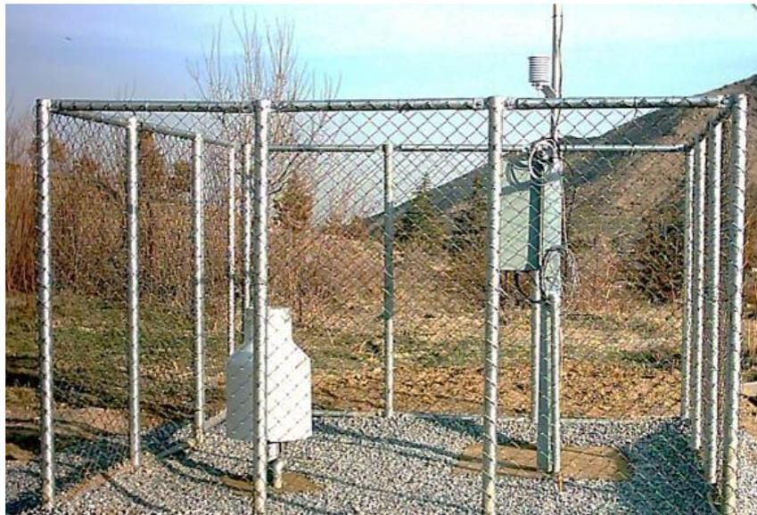
Nota. Pluviómetro de marca Sutron. Fuente:
