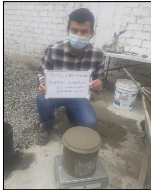
FIGURA 30. Pesado de concreto + recipiente para un diseño de mezclas.
