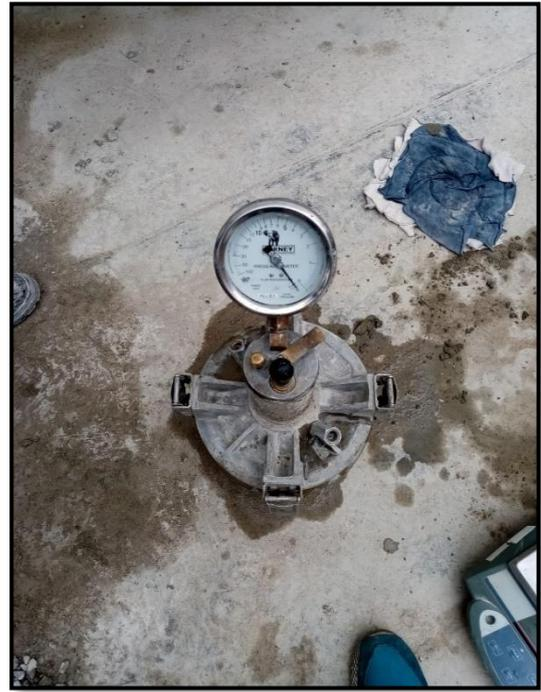
FIGURA 32. Lectura de la olla Washington del contenido de humedad.
