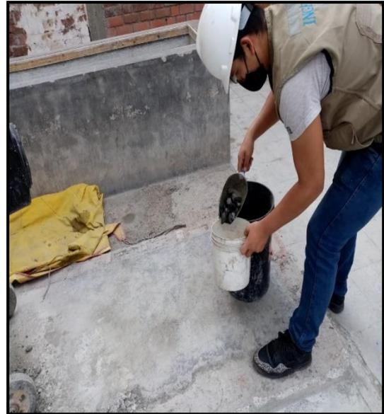
FIGURA 13. Muestra sumergida en agua por 24h
