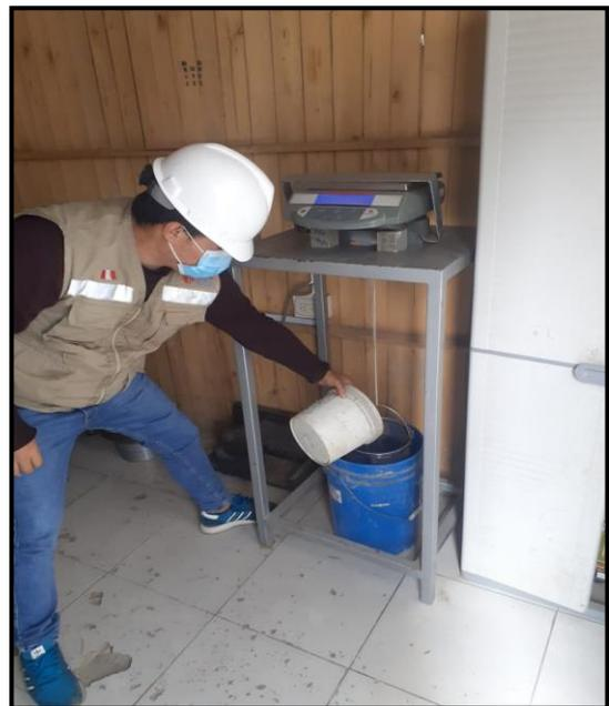
FIGURA 15. Muestra saturado en agua
