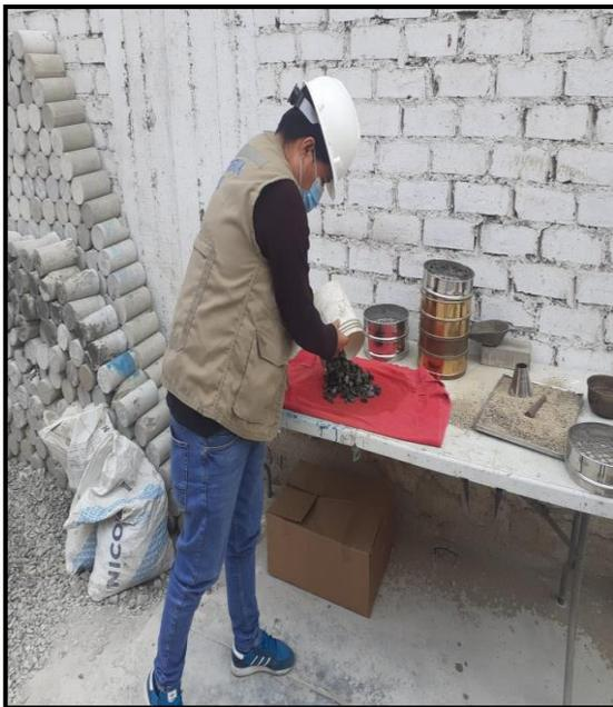
FIGURA 14. Agregado saturado superficialmente.
