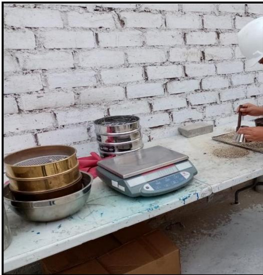
FIGURA 11. Pesado de los agregados en cada uno de los tamices usados para el ensayo.
