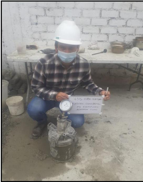
FIGURA 31. Ensayo de contenido de humedad con la olla Washington.
