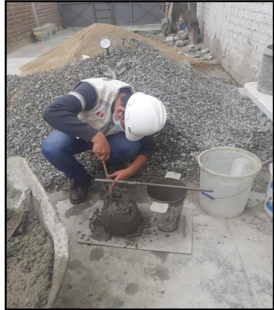
FIGURA 36. Medida del asentamiento del concreto (slump).
