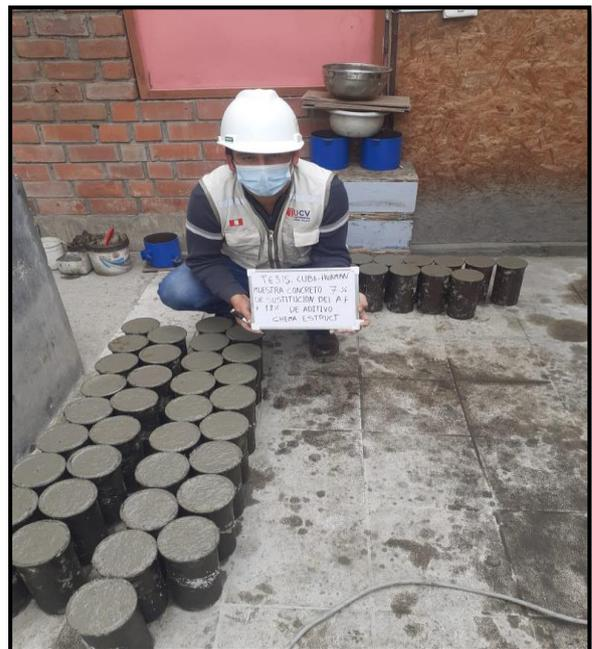
FIGURA 38. Probetas de concreto.
