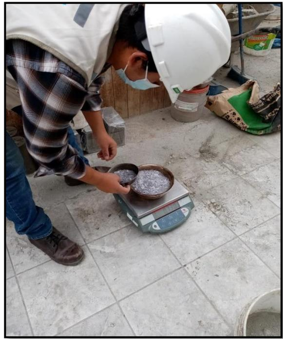
FIGURA 24. Pesado de tereftalato de polietileno para agregar al diseño de mezclas de acuerdo a los distintos porcentajes.
