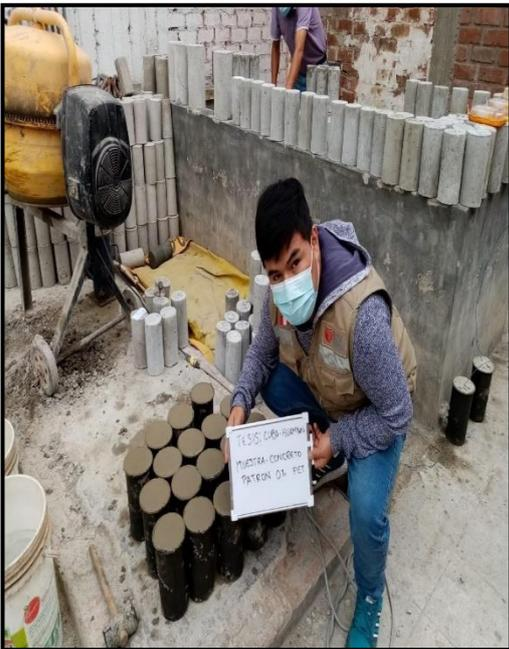
FIGURA 37. Probetas de concreto.
