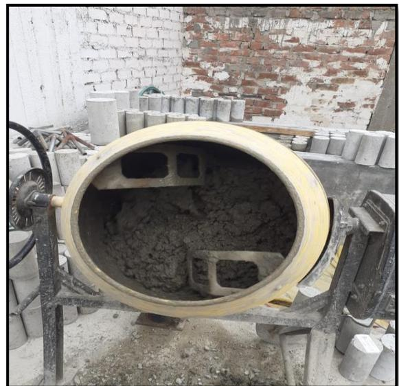
FIGURA 26. Proceso de mezclado en el trompo con las cantidades usadas para cada diseño de mezclas.
