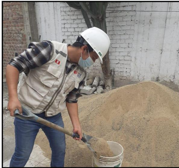
FIGURA 8. Agregados finos usados en los ensayos.
