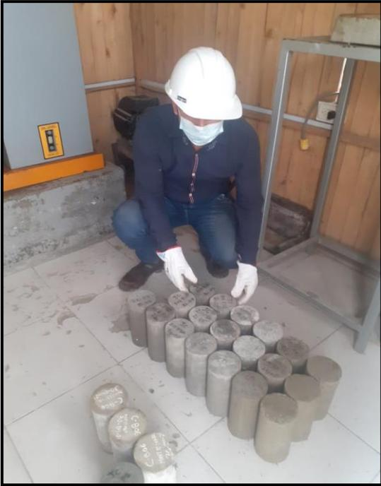
FIGURA 39. probetas de concreto que fueron ensayadas
