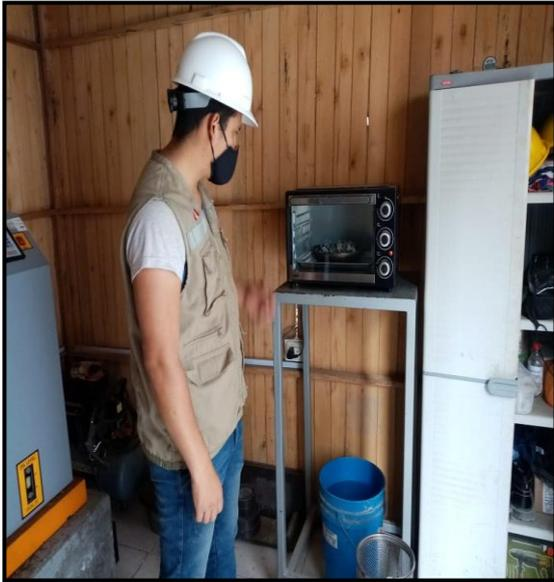
FIGURA 12. Agregado secado en horno por 24 h.
