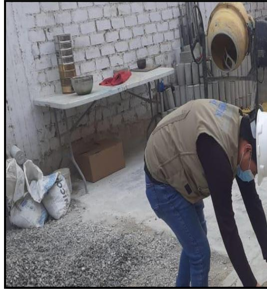
FIGURA 10. Tamizado de los agregados para Ensayo granulométrico.
