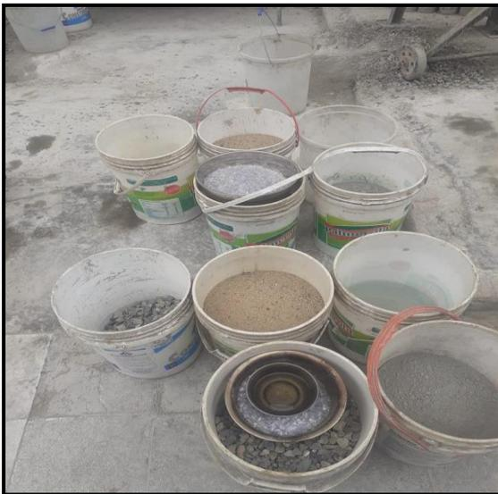
FIGURA 25. Materiales pesados según las cantidades del diseño de mezcla estudiado, listos para ser mezclados.
