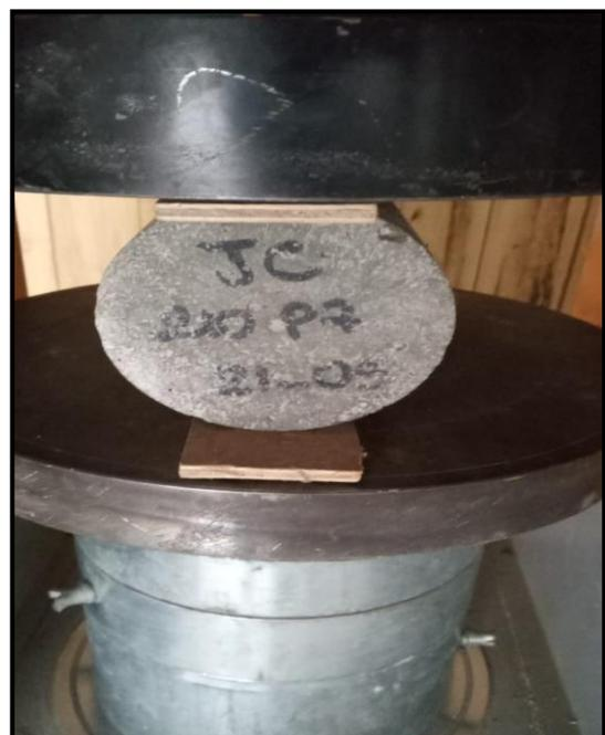
FIGURA 42. Rotura de probeta diametral para ensayo a tracción.
