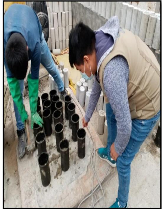
FIGURA 28. Llenado de probetas.
