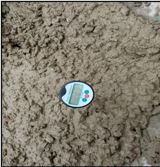
FIGURA 33. Lectura de la temperatura del concreto (ensayo de temperatura)
