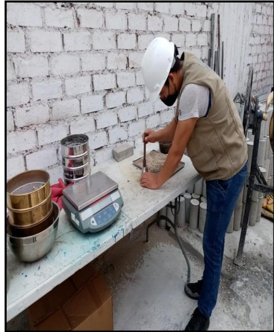
FIGURA 17. Comprobación de secado de Muestra
