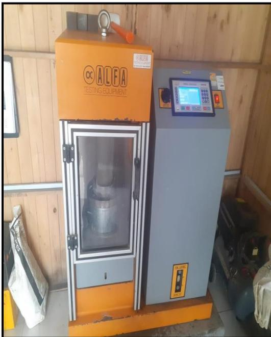
FIGURA 41. Rotura de probeta en laboratorio.
