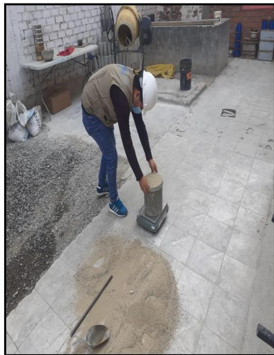
FIGURA 22. Pesado de recipiente + agregado compactado.
