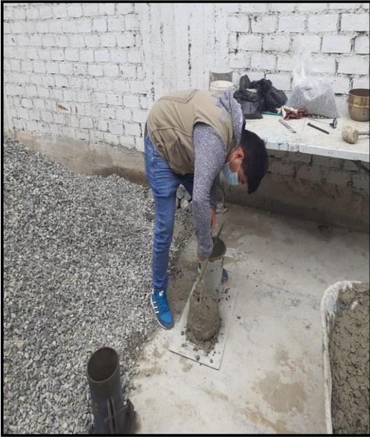
FIGURA 35. Medida del asentamiento del concreto (slump).
