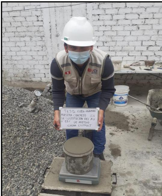
FIGURA 29. Pesado de concreto + recipiente para un diseño de mezclas.
