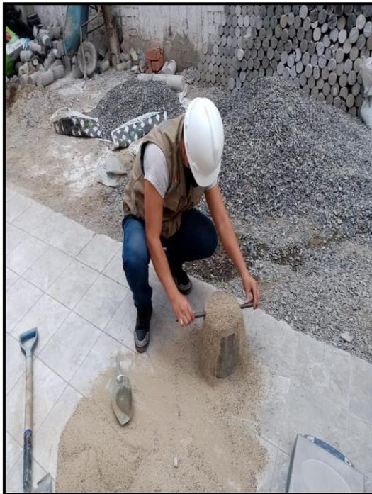
FIGURA 21. Nivelado de agregado con varilla, previamente se compacto 1/3 y 2/3
