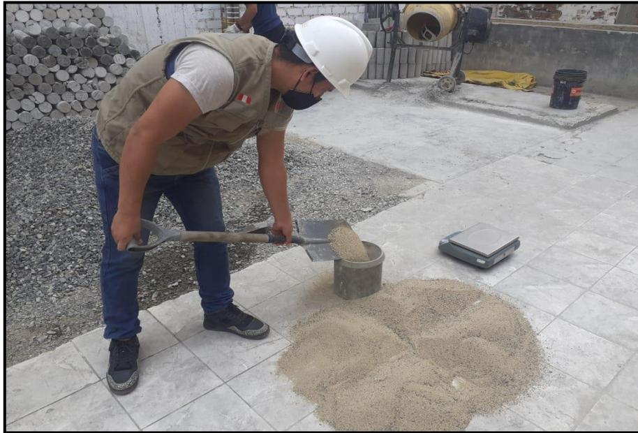
FIGURA 20. Llenado de agregado para peso unitario suelto (recipiente +agregado suelto).
