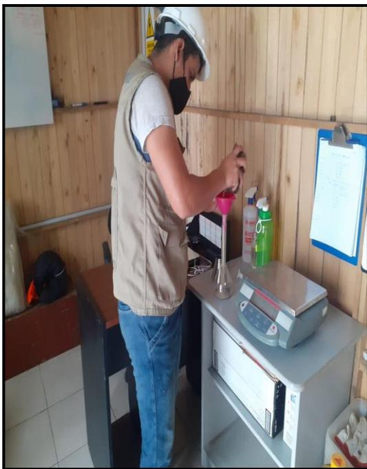
FIGURA 18. Picnómetro con muestra.
