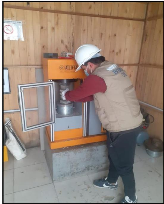
FIGURA 40. Rotura de probetas por compresión.
