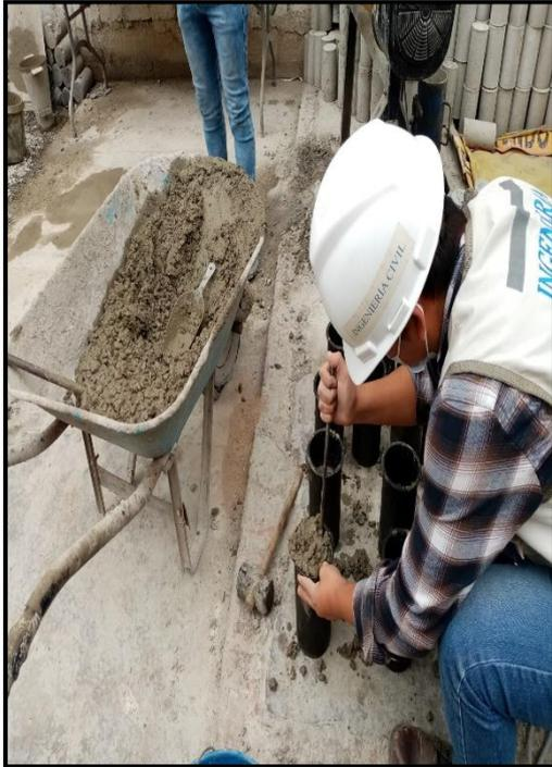
FIGURA 27. Llenado de probetas con cada diseño de mezcla estudiada.
