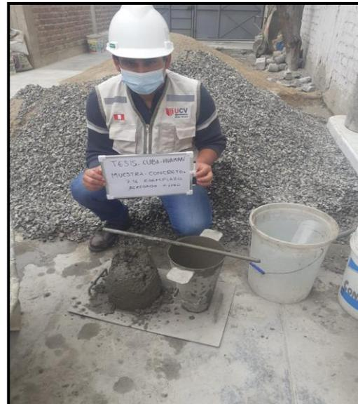
FIGURA 34. Determinación del asentamiento del concreto (slump)
