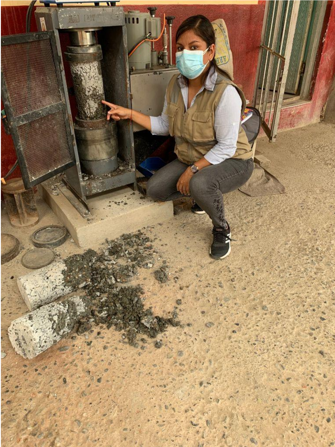
ROTURA DE PROBETAS, ENSAYO A LA REISTENCIA DE COMPRESION A LOS 14 DÍAS
