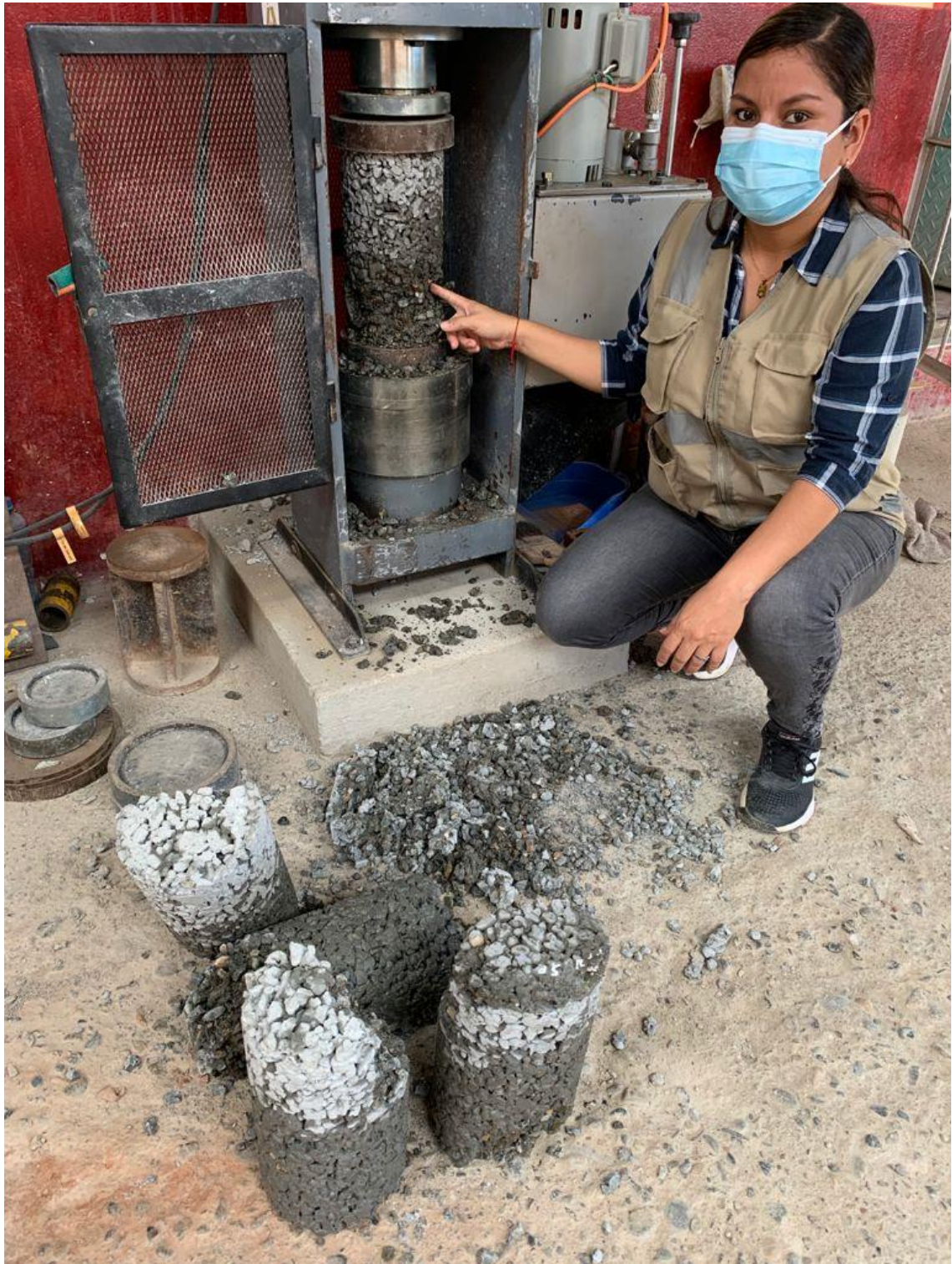
Rotura de probetas ensayo a la resistencia de compresión a los 7 días
