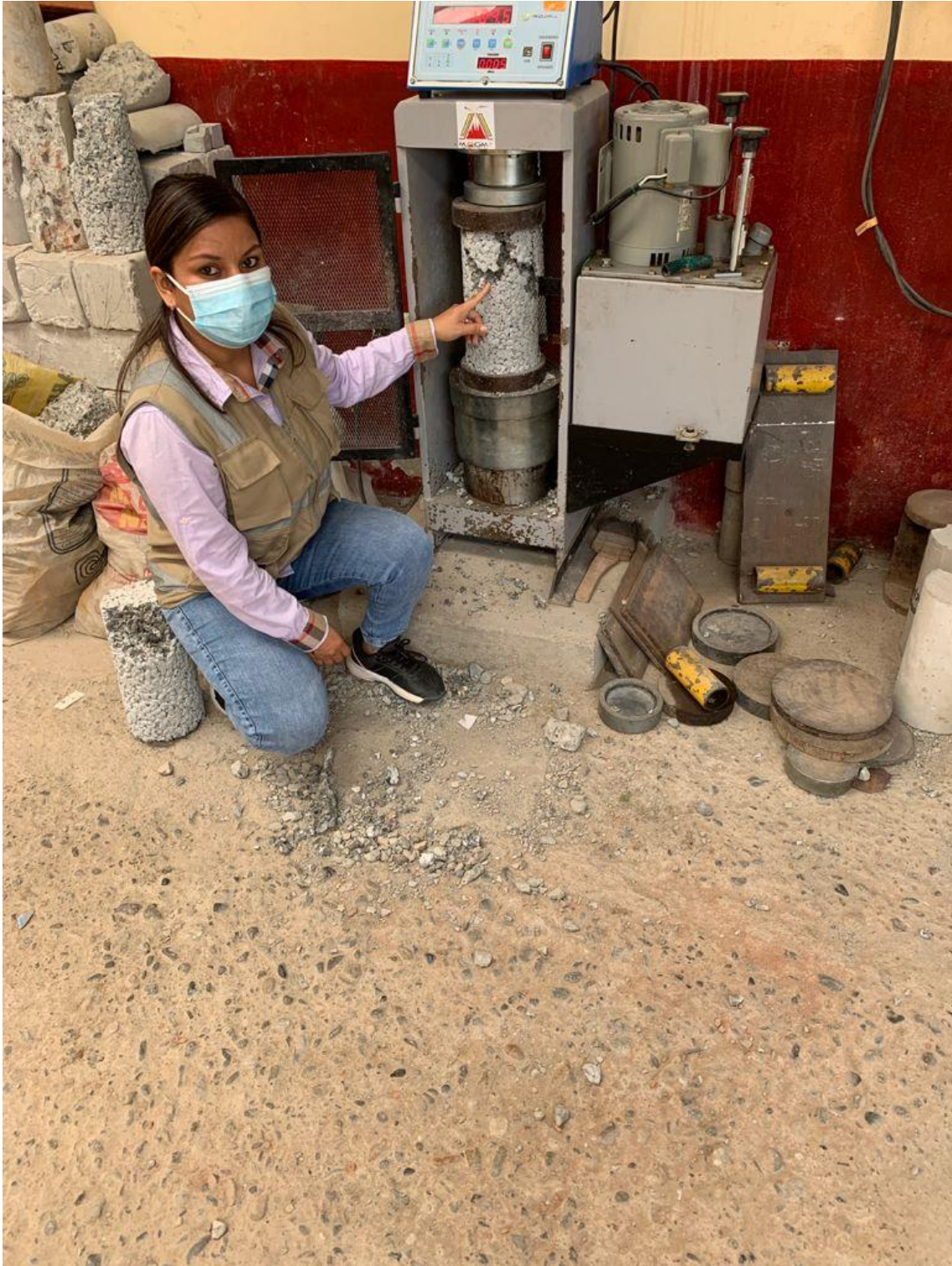
ROTURA DE PROBETAS, ENSAYO A LA REISTENCIA A LOS 28 DÍAS
