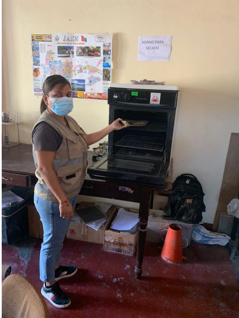
Secado de agregados para obtener el contenido de humedad
