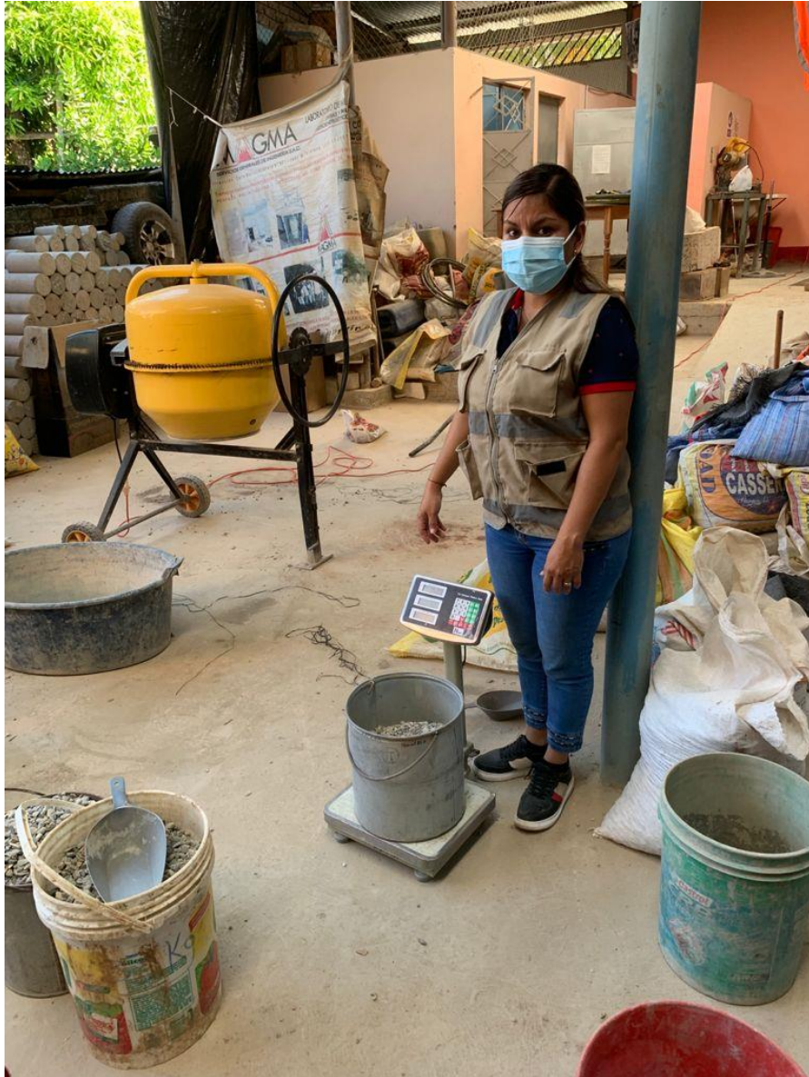
Pesaje de material para la elaboración de probetas
