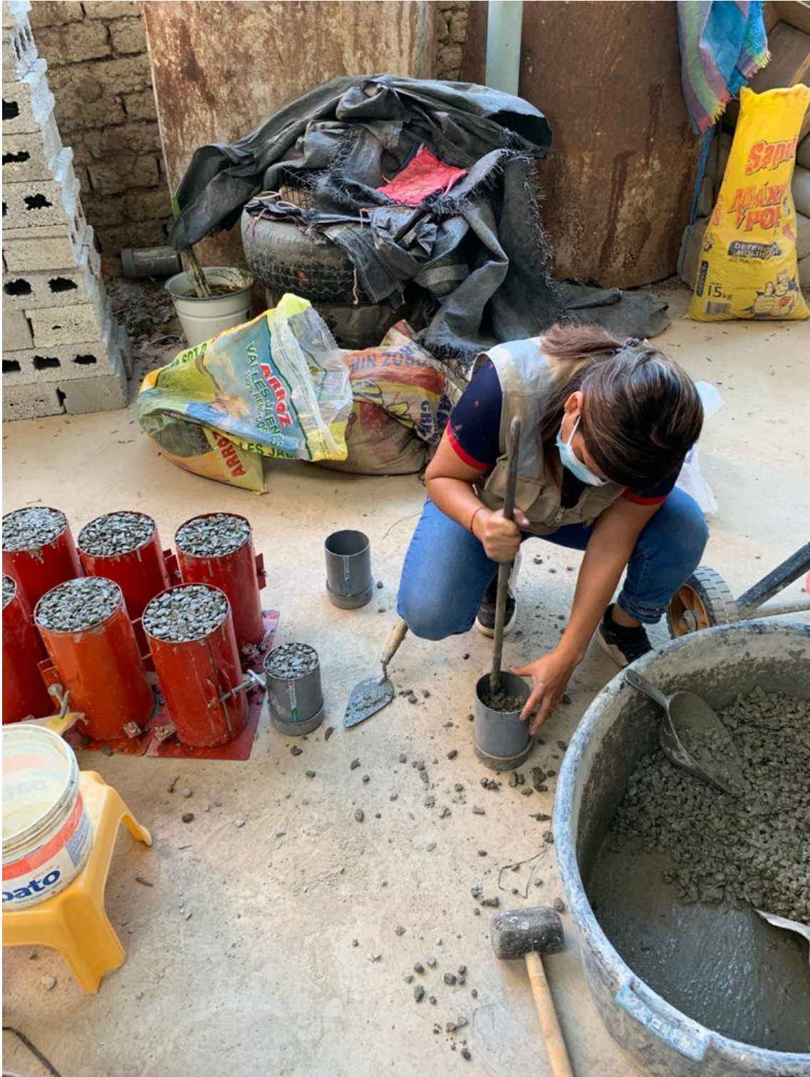
Elaboración de probetas para el ensayo de resistencia a compresión y ensayos de permeabilidad
