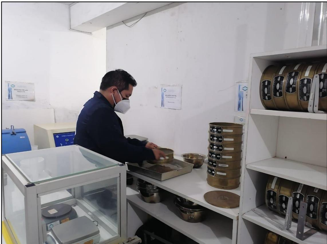
FOTOGRAFIAS DE LOS ENSAYOS DE LABORATORIOS DE LAS MUESTRAS DE LAS CALICATAS TOMADAS LAS AV. LAS PALMAS – PACHACAMAC
