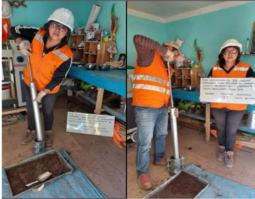
Figura 10. Compactación de la muestra Fuente: Elaboración propio
