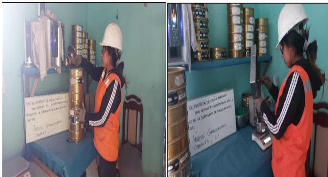
Figura 3. Se visualiza el tamizado y peso de la muestra retenida Fuente: Elaboración propio
