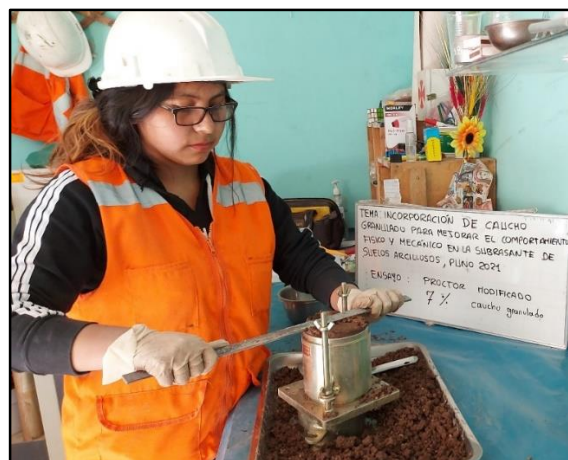
Figura 11. Enrasando la muestra compactada Fuente: Elaboración propio
