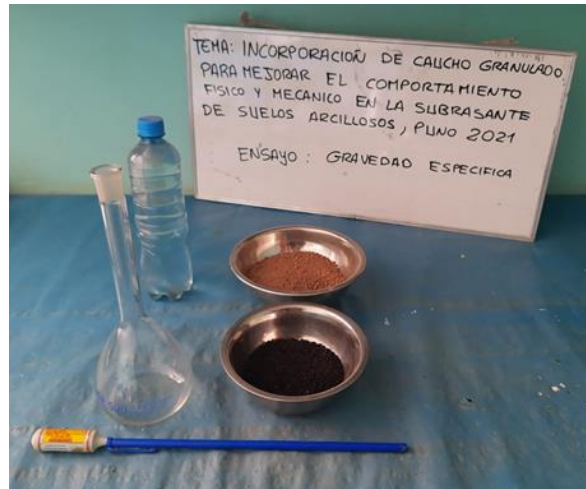
Figura 6. Equipos a utilizar en el ensayo de Gravedad Especifica Fuente: Elaboración propio
