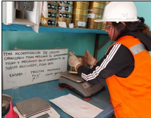
Figura 12. Peso de la muestra compactada más molde Fuente: Elaboración propio
