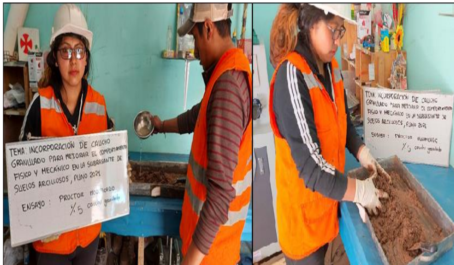
Figura 9. Proceso para la homogenización de la muestra Fuente: Elaboración propio
