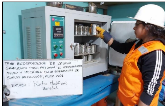
Figura 13. Secado de humedad del Próctor en el horno Fuente: Elaboración propio
