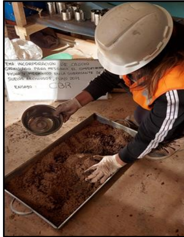
Figura 14. Agregando agua para la homogenización para la muestra del CBR Fuente: Elaboración propio
