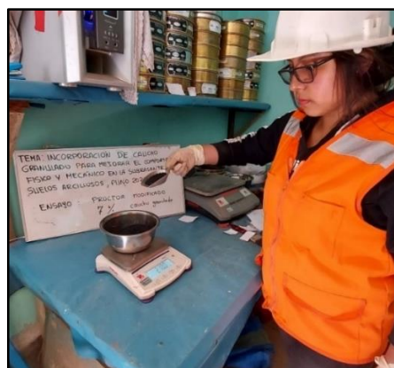
Figura 7. Peso del caucho granulado para la muestra de Proctor Fuente: Elaboración propio
