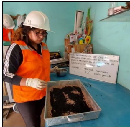
Figura 8. Se visualiza la mezcla del material más la incorporación de caucho granulado Fuente: Elaboración propio
