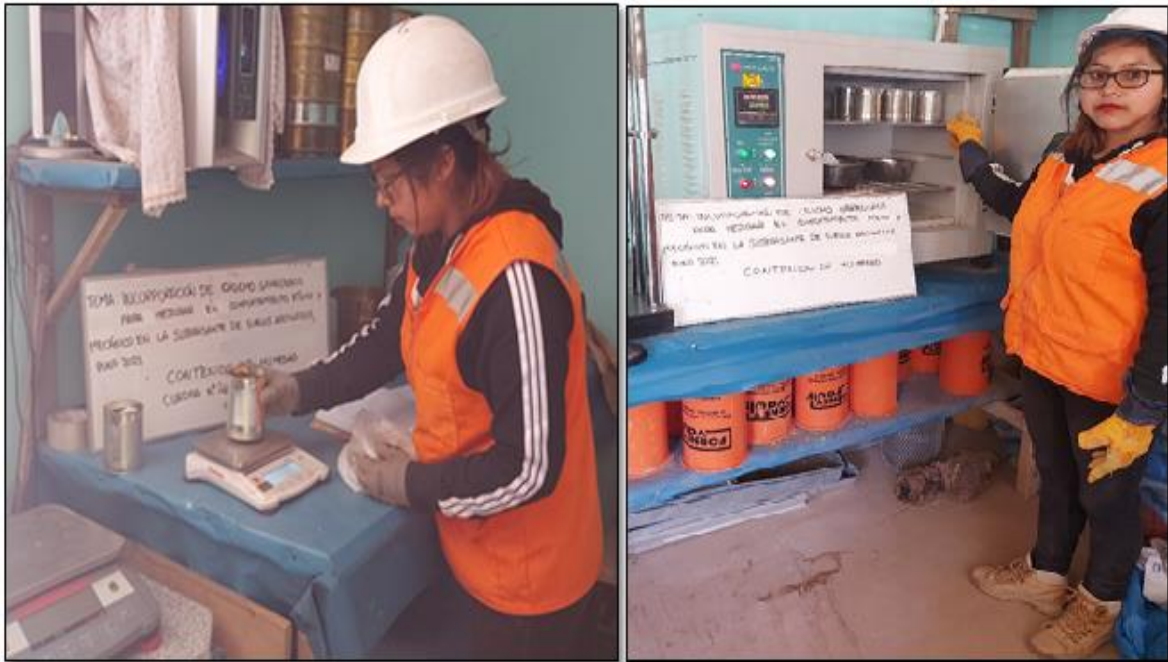
Figura 2. Peso de muestra de Contenido de Humedad y secado en el horno Fuente: Elaboración propio
