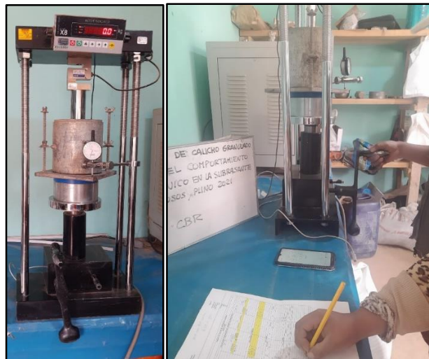
Figura 16. Vista del equipo de penetración Fuente: Elaboración propio
