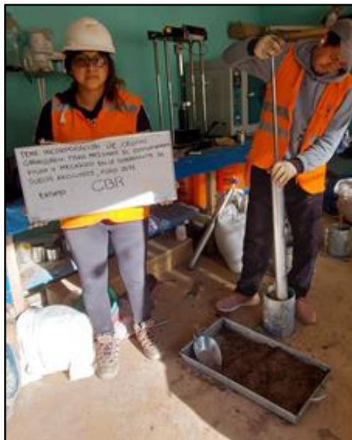
Figura 15. Compactación de la muestra para el CBR Fuente: Elaboración propio
