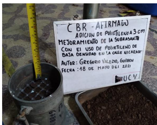
Figura 26. Compactación de CBR-afirmado
