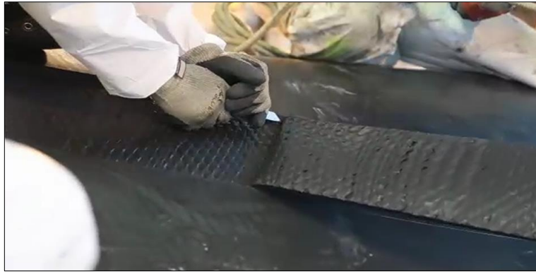
Figura 48. Realización de la ventana
