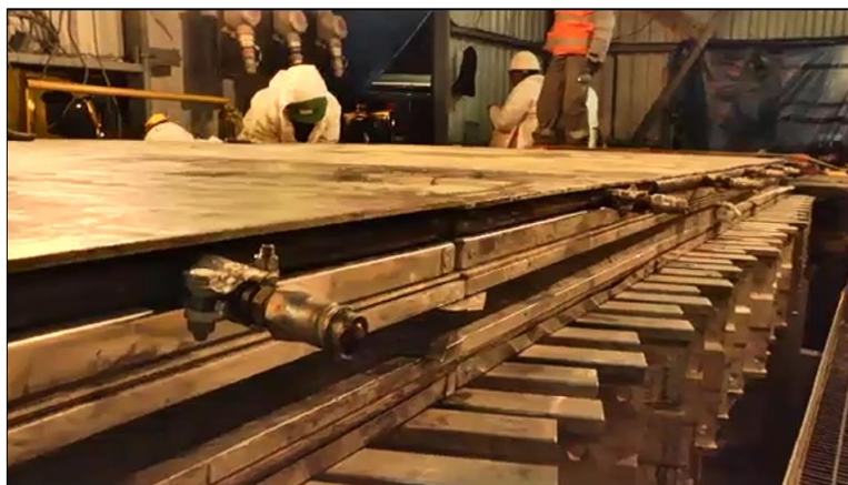
Figura 68. Placas delgadas de aluminio sobre bolsas de presión.
