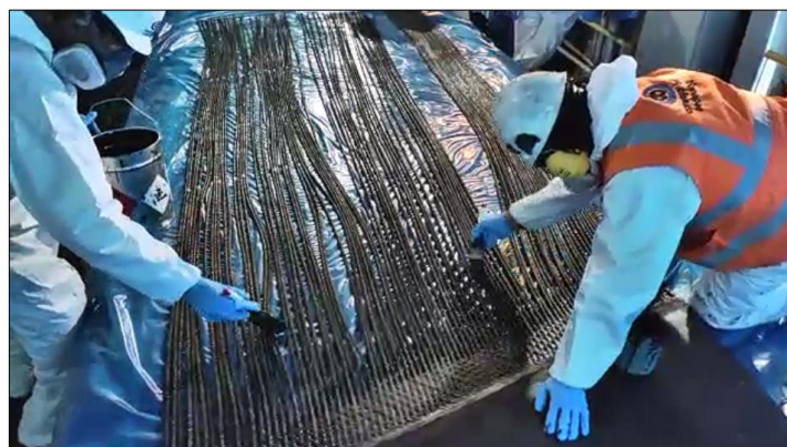
Figura 54. Aplicación de cemento vulcanizante
