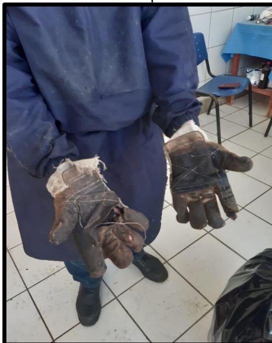
Figura 13. Epp rotos y deficientes.
