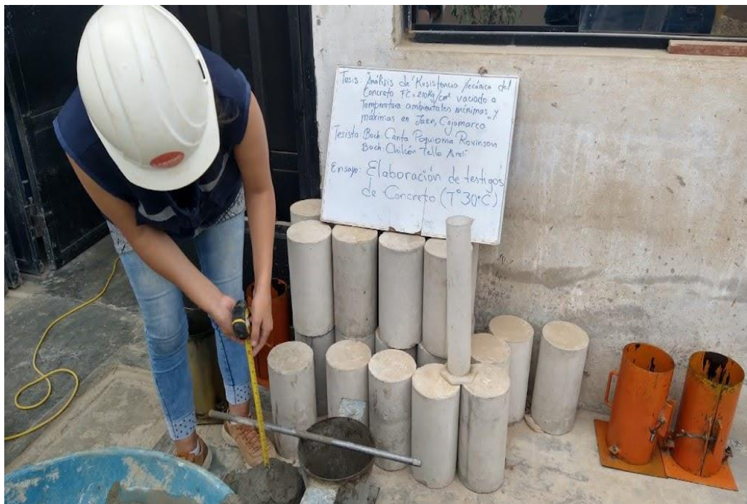
Figura 14. Laboración de probetas de concreto a temperatura ambiental de 30 °C.
