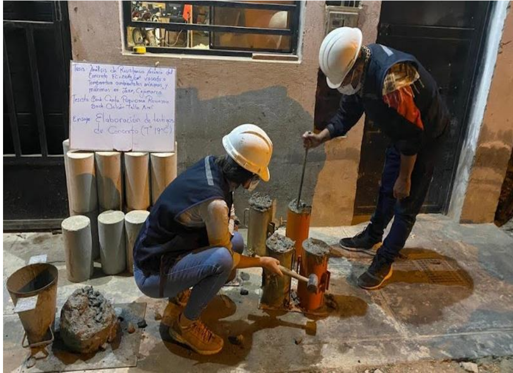
Figura 13. Vaciado de probetas de concreto a temperatura ambiental de 19 °C.
