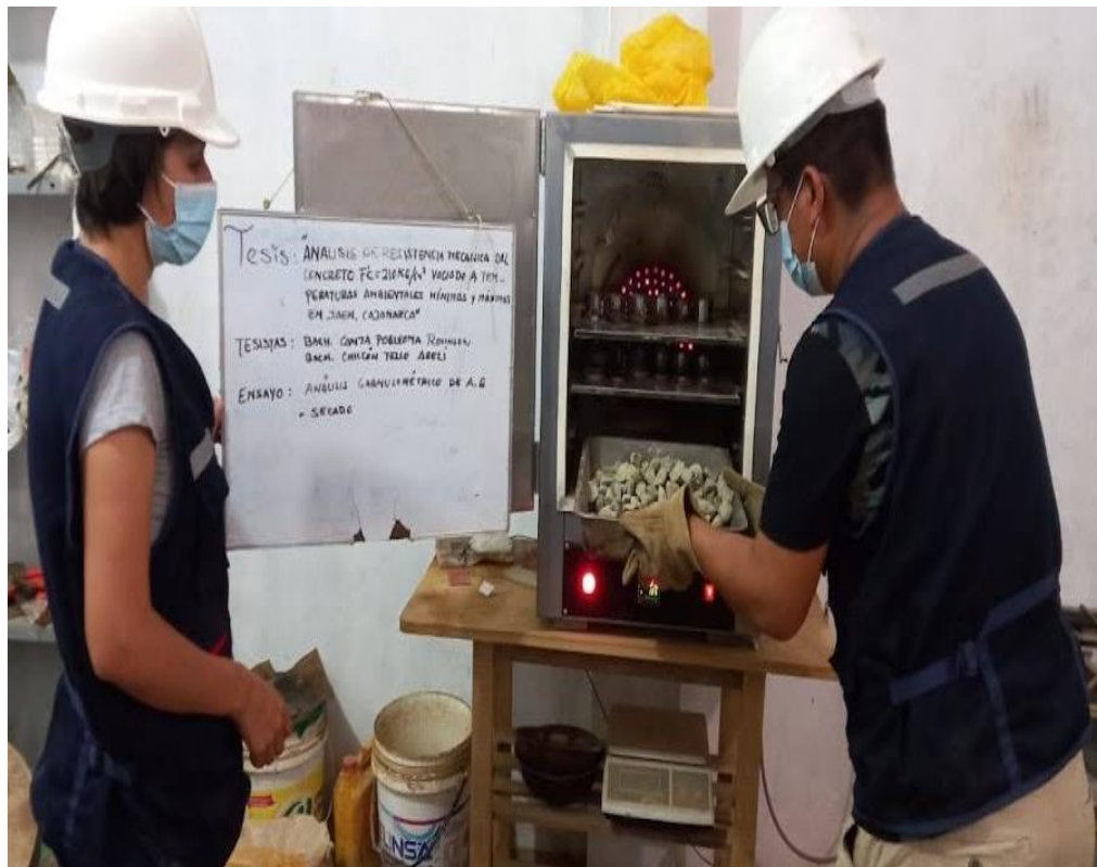
Figura 6. Secado de agregado grueso.
