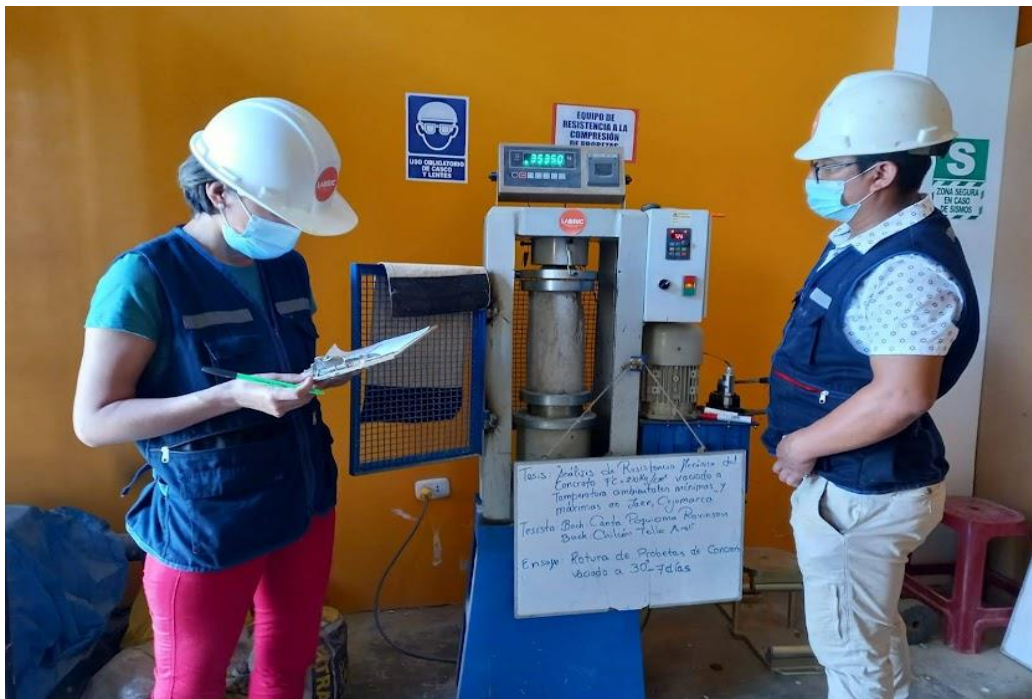
Figura 16. Ensayo de resistencia a la compresión probetas vaciadas a 30 °C – 7 días.
