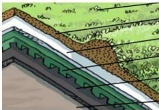
Ilustración N° 94 Elementos de un techo verde Fuente: (Bioguía), 2013
