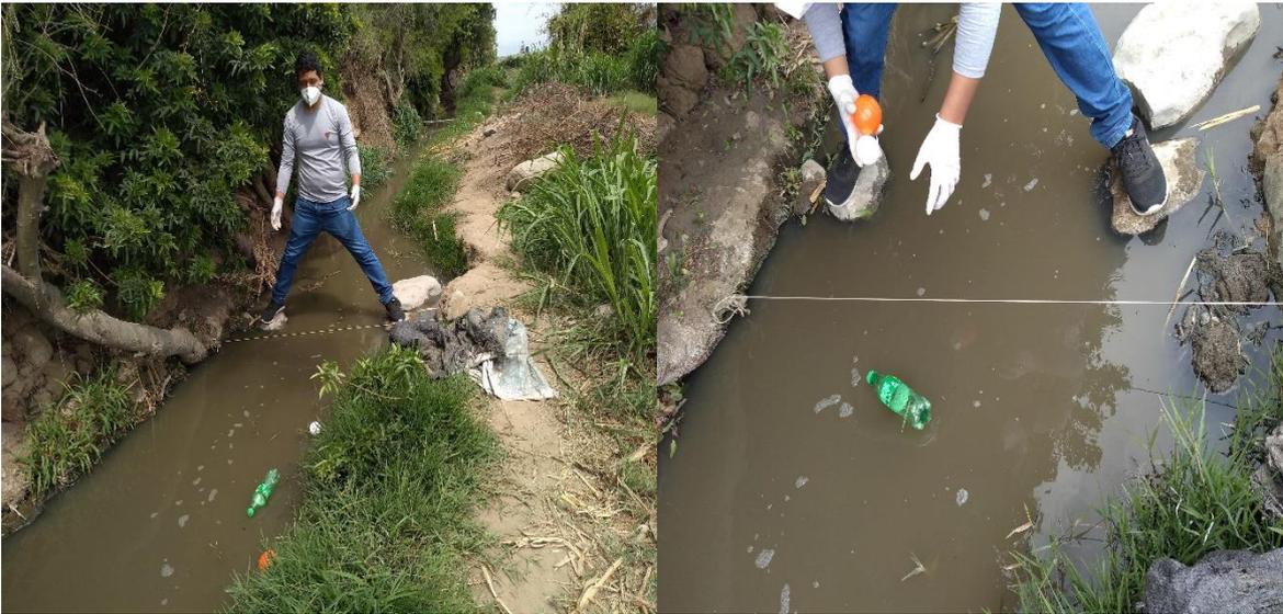
Figura 26: Materiales utilizados para cálculo del caudal
