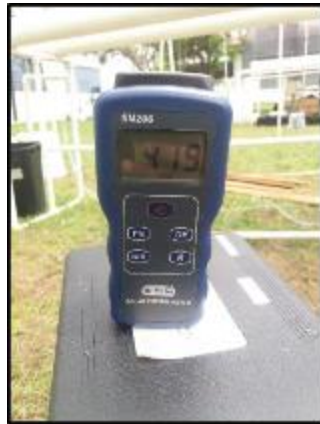
Figura 6. Cálculo de Radiación Solar-Piranómetro digital - Medidor de radiación de energía solar PCE-SPM 1.
