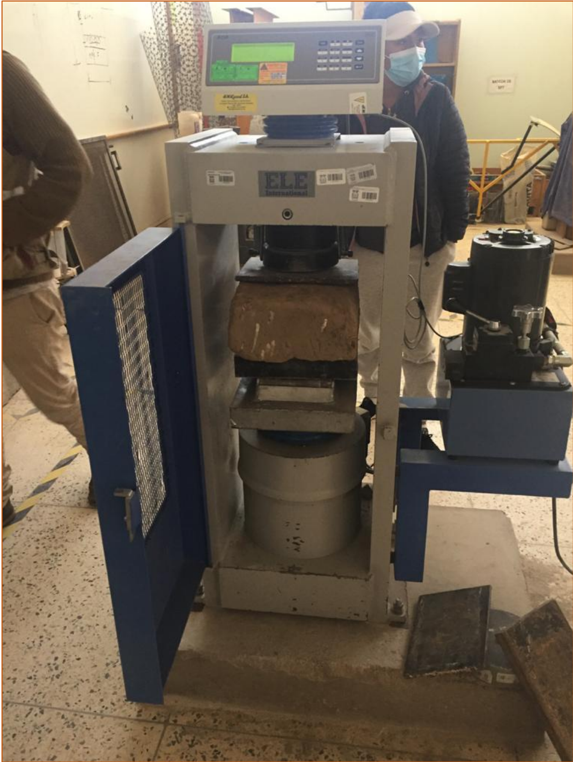
Fig. 5.- Ensayo a Compresión 1
