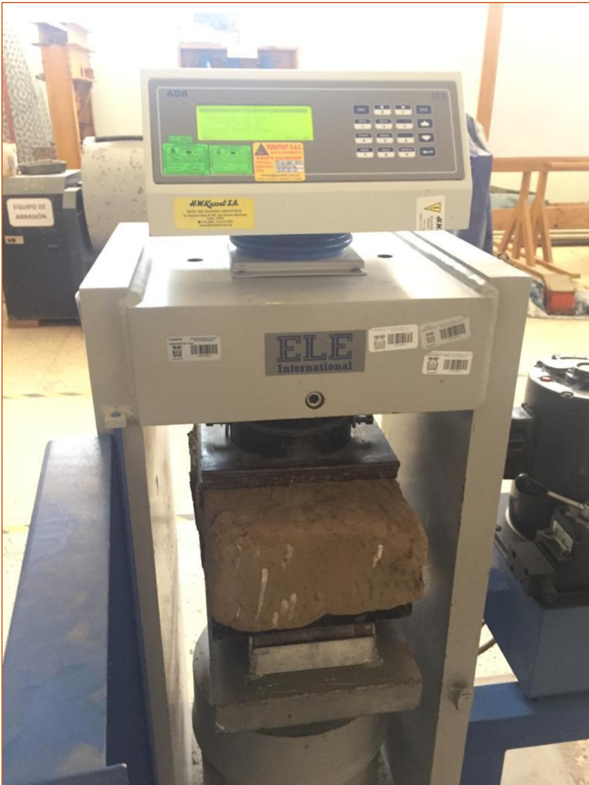
Fig. 6.- Ensayo a Compresión 2
