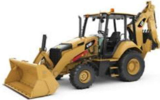
Figura 08: Retroexcavadora marca Cat 416F2 – 86HP
