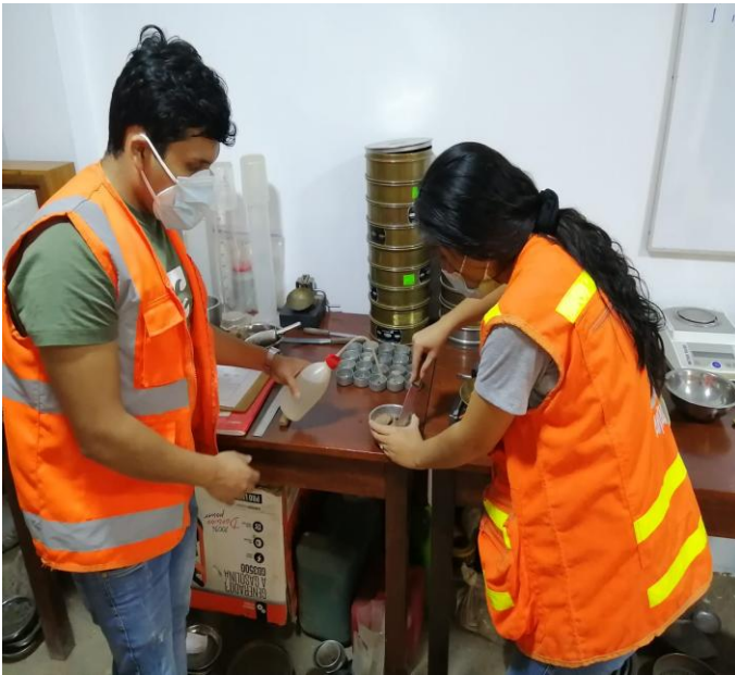
Figura N° 28: Mezcla de CCC mas arcilla con el agua Fuente: Elaboración propia
