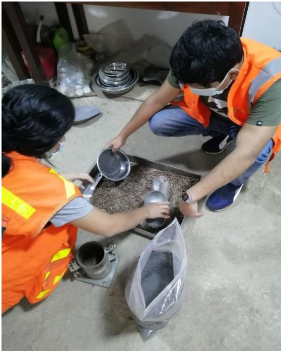
Figura N° 31: Añadiendo la CCC y Cuarteo Fuente: Elaboración propia
