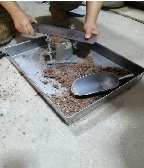
Figura N° 34: Nivelando el material excedente Fuente: Elaboración propia
