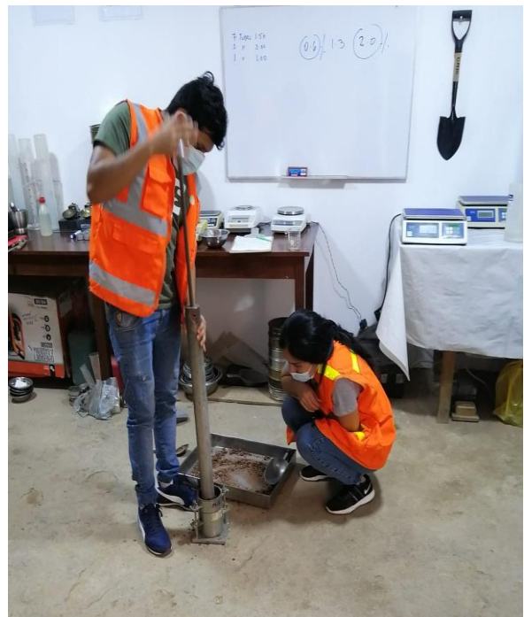
Figura N°32: Realizando la Compactación Fuente: Elaboración propia
