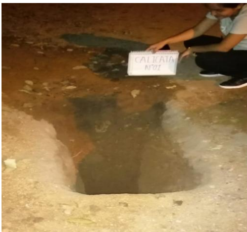
Figura 04: Calicata - 1 Fuente: Elaboración propia 2021
