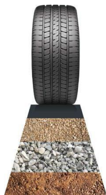
Figura 12. Capas de un pavimento Fuente: (Tratamientos superficiales de alto desempeño, 2019)
