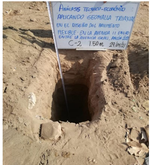
FOTOGRAFIA 4: Calicata N°2, dimensión 1.00mx1.00mx1.50m
