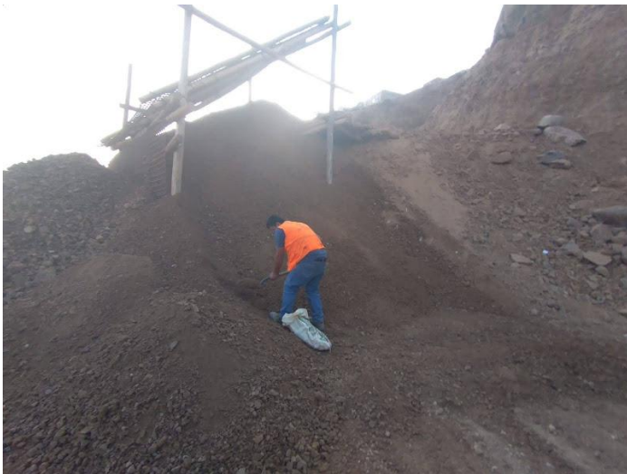
FOTOGRAFIA 9: Extracción de la muestra de la Cantera Carambuco - Carabayllo
