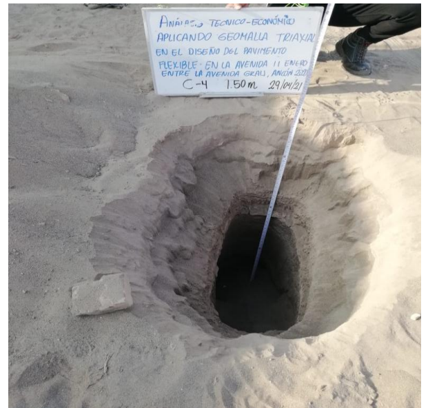
FOTOGRAFIA 8: Calicata N°4, dimensión 1.00mx1.00mx1.50m
