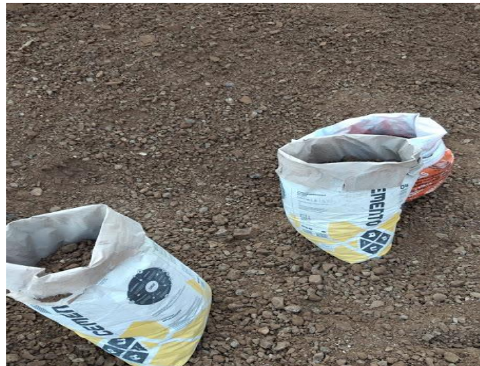
FOTOGRAFIA 10: Extracción de la muestra del afirmado en la Cantera Carambuco - Carabayllo
