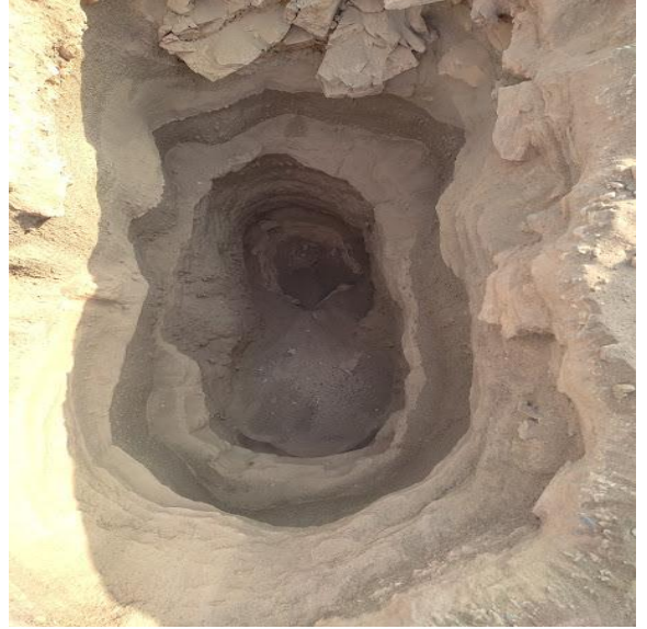
FOTOGRAFIA 2: Calicata N°1, dimensión 1.00mx1.00mx1.50m
