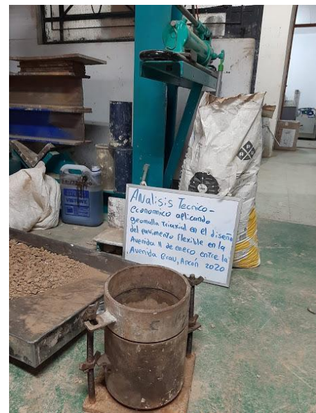
FOTOGRAFIA 16: Molde para prueba de Compactación Proctor Estándar.
