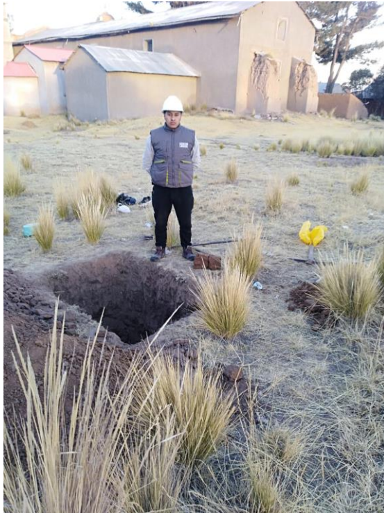
Figura 32: Calicata en el patio del Templo
