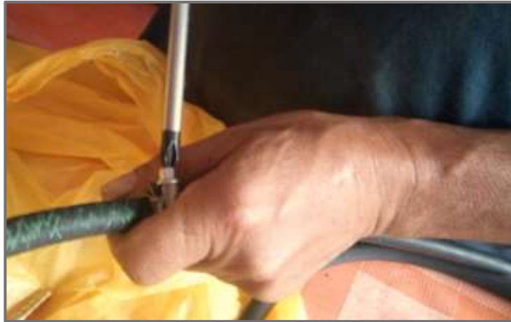
Figura 13 Colocación de Abrazadera a la Manguera
