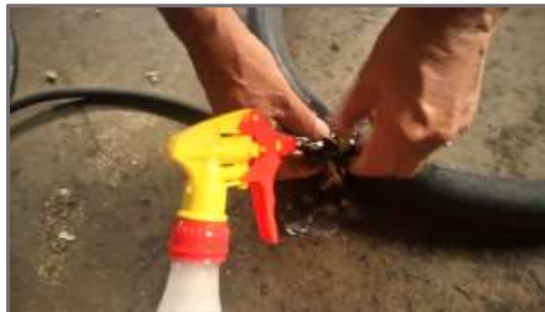
Figura 14 Prueba de Fuga de Aire a la Manguera y a la Cámara de la Llanta
