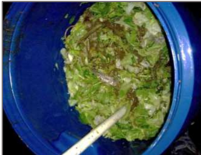
Cargado de Digestor Anaeróbico con Pre Compost
