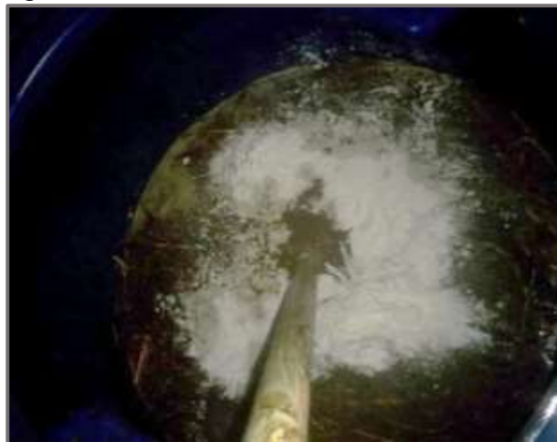
Cargado del Digestor Anaeróbico con Carbonato de Calcio
