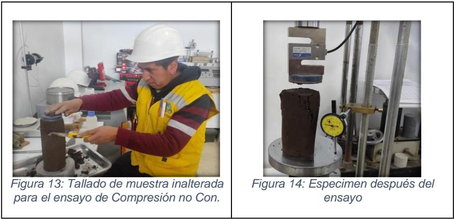
Figura 13: Tallado de muestra inalterada para el ensayo de Compresión no Con.
