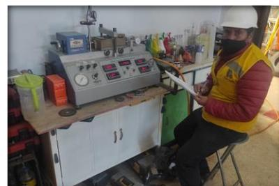
*Figura 11: Ensayo de corte directo*
