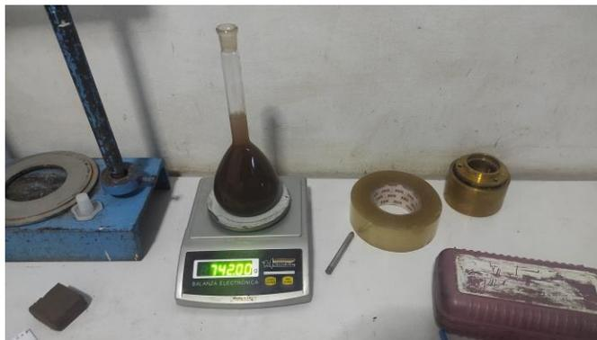
Foto 15: Pesado de fiola + muestra superficialmente seca (MSS) + agua para el ensayo de gravedad específica del suelo.
