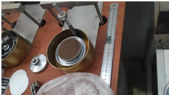
**Foto 12: Tallado de muestra para consolidación unidimensional.**
