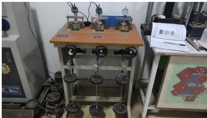
Foto 18: Ensayo de consolidación unidimensional.
