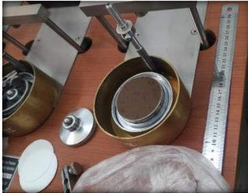
Figura 16: Colocado del espécimen al molde de consolidación
