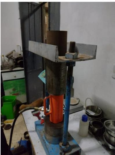
Foto 20: En tracción de la muestra remoldeada del molde.
