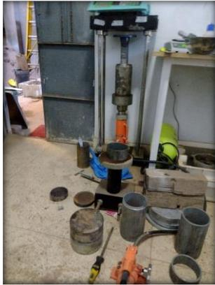
*Figura 8: Uso de gata hidráulica para el remoldeo*
