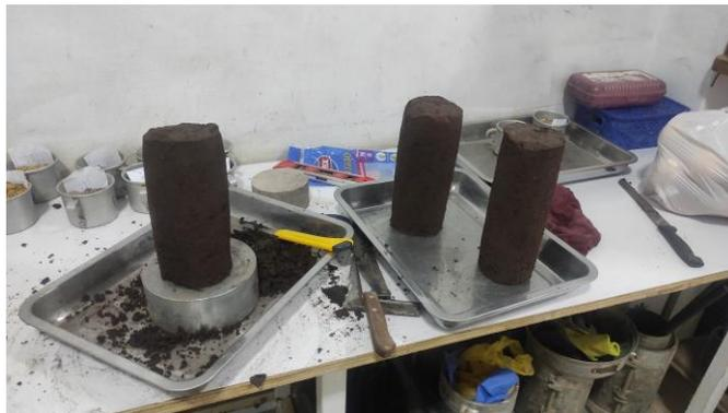
**Foto 11: Tallado de muestra para compresión no confinada.**
