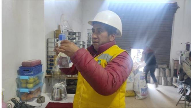
Foto 13: Pesado de fiola + agua para el ensayo de gravedad específica del suelo.
