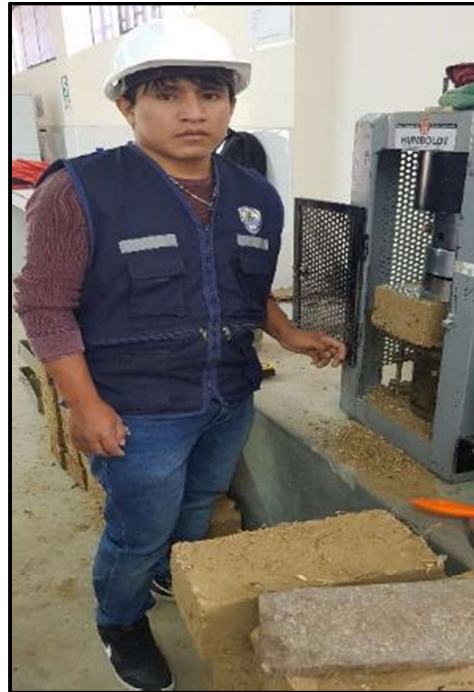
Gráfico 26 Ensayo a la resistencia a la compresión a los adobes
