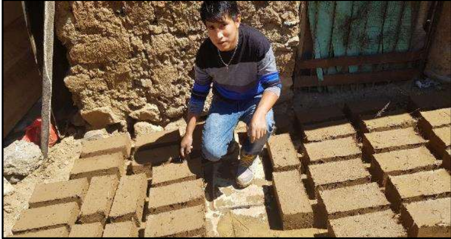
Gráfico 24 Muestra de adobes desencofrados
