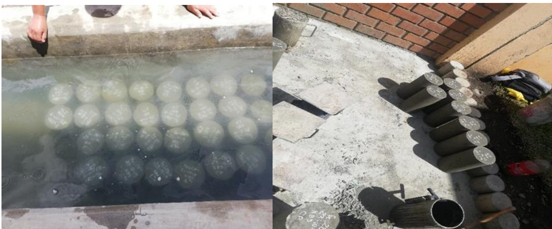
Fotografía N° 12: Proceso de curado y desencofrado de probetas.
