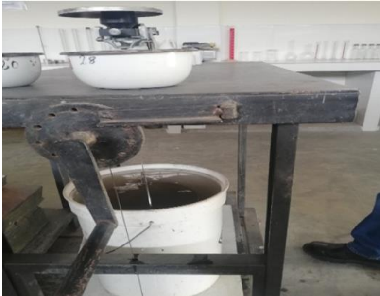
Fotografía N° 05: Peso específico del agregado grueso
