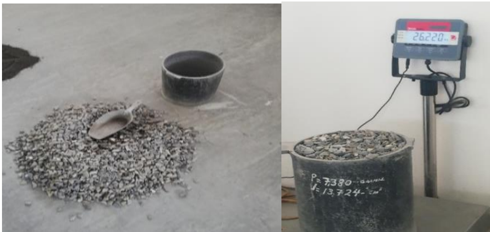
Fotografía N°03: Peso unitario seco del agregado.
