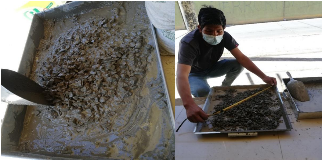
Fotografía N° 11 Ensayo de escurrimiento
