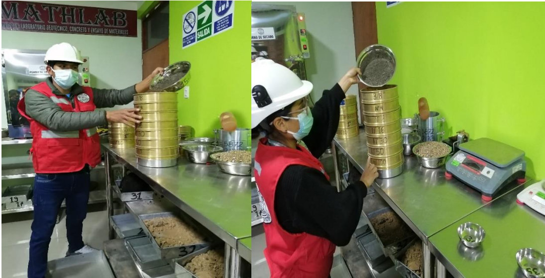
Fotografía N° 02: Análisis granulométrico de los agregados.
