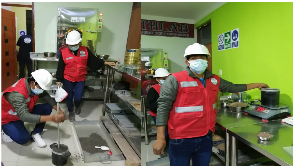
Fotografía N°08: Peso unitario compactado del agregado
