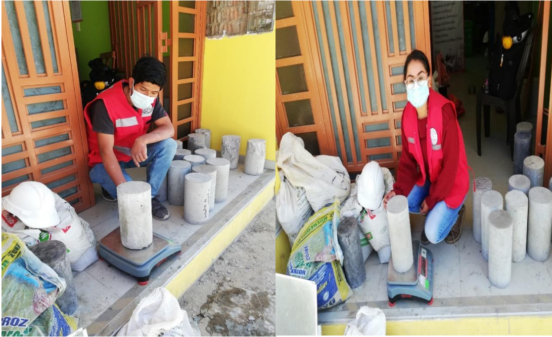
Fotografía N°17: Ensayo de densidad del concreto.
