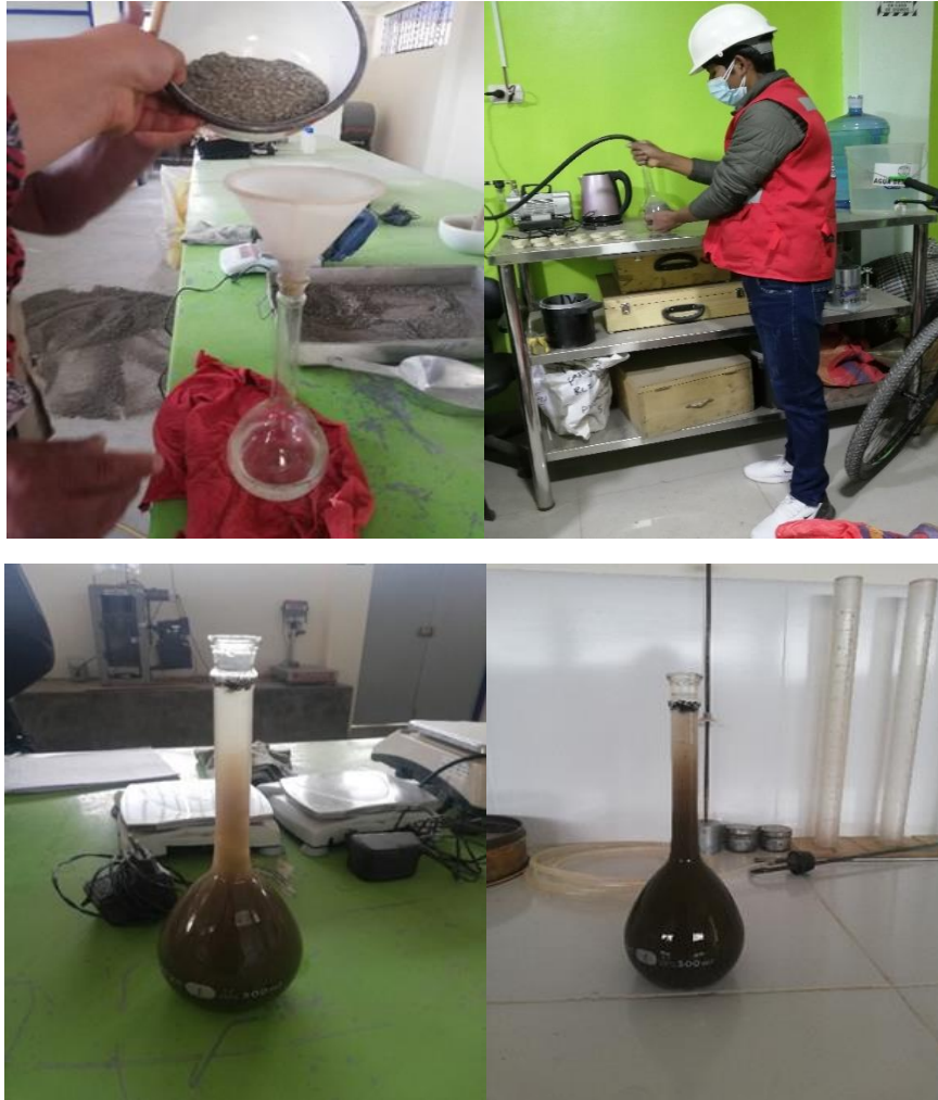
Fotografía N° 07: Peso específico y absorción del agregado fino.
