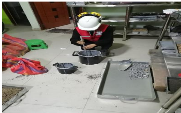
fotografía N°04: peso unitario compactado del agregado grueso
