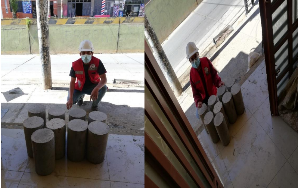
Fotografía N° 14: Desencofrado de probetas para rotura a los 28 días.
