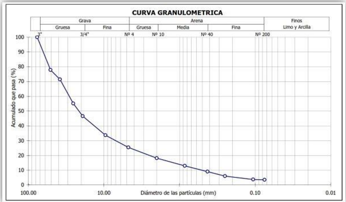
Figura N°86 – “Curva de Granulometría”
