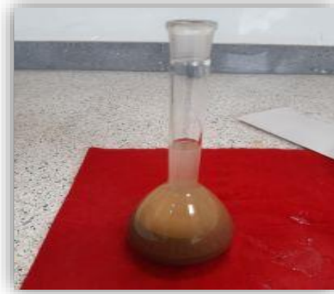
Figura N°96 – Agregado sumergido F. agua
