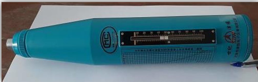
Figura N°68 – componentes del esclerómetro HT-225B
