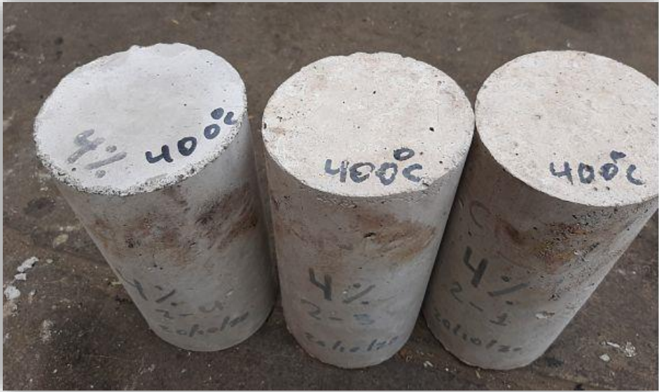
FiguraN°148 – Con lana de roca no se visualiza fisuras visibles hasta 400°C de temperatura del horno
