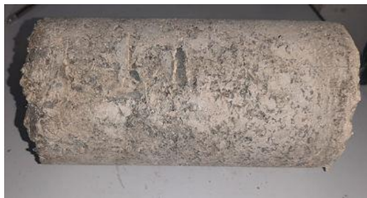
Figuras N° 246 – Probeta con lana de roca, pero fibra y no molida
