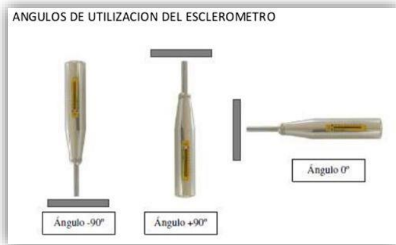
Figura N°69 – Ángulos a trabajar con el Esclerómetro.
