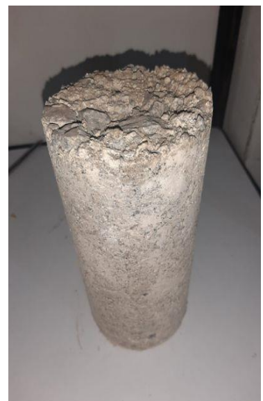
Figuras N° 246 – Probeta con lana de roca, pero fibra y no molida
