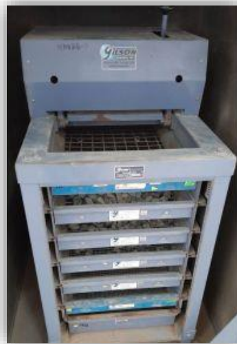
Figura N°98 – Proceso de (zarandeo o agitar) en equipo electrónico
