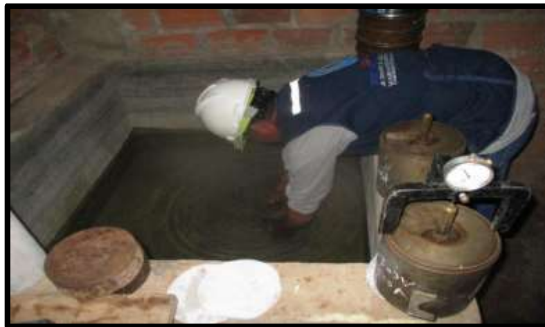
Personal técnico sumergiendo la muestra de ensayo de CBR
