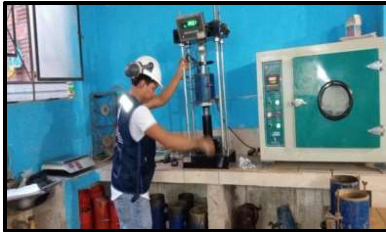
Personal técnico realizando la penetración de ensayo CBR
