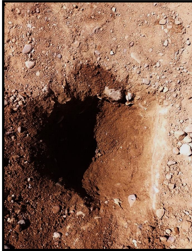
Ilustración 9: Calicata terminada. Fuente: Elaboración propia
