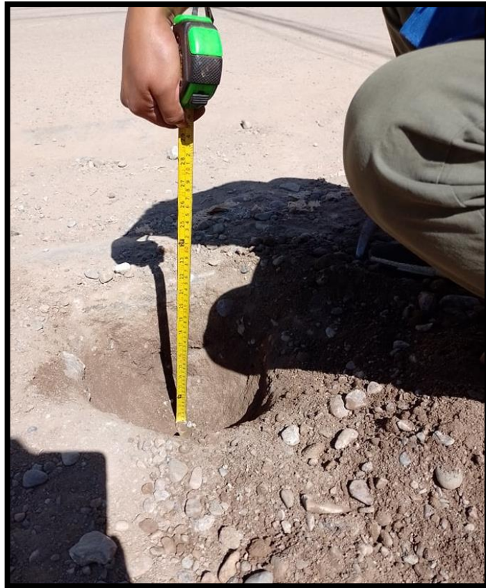
Ilustración 7: Medición de la calicata. Fuente: Elaboración propia
