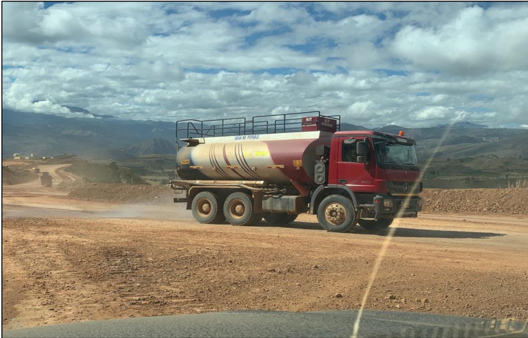
Fotografía 13: Cisterna de agua para control de polvo
