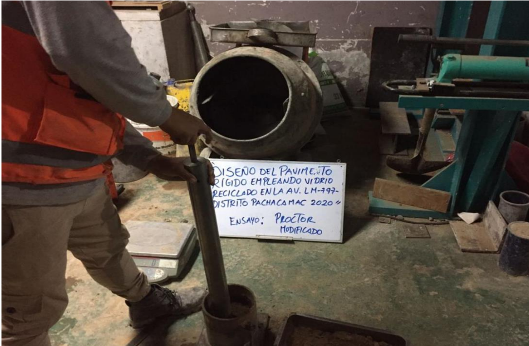
Fotografía 10. Investigador realizando ensayo de proctor modificado.
