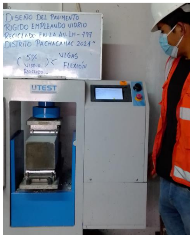
Fotografía 15. Ensayo de especímenes de concreto a la flexión
