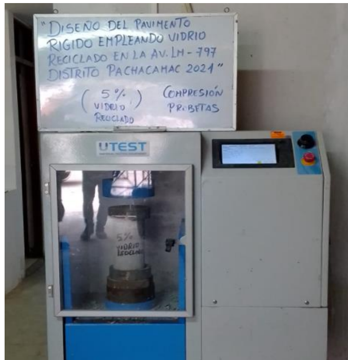
Fotografía 14. Ensayo de especímenes de concreto a la compresión
