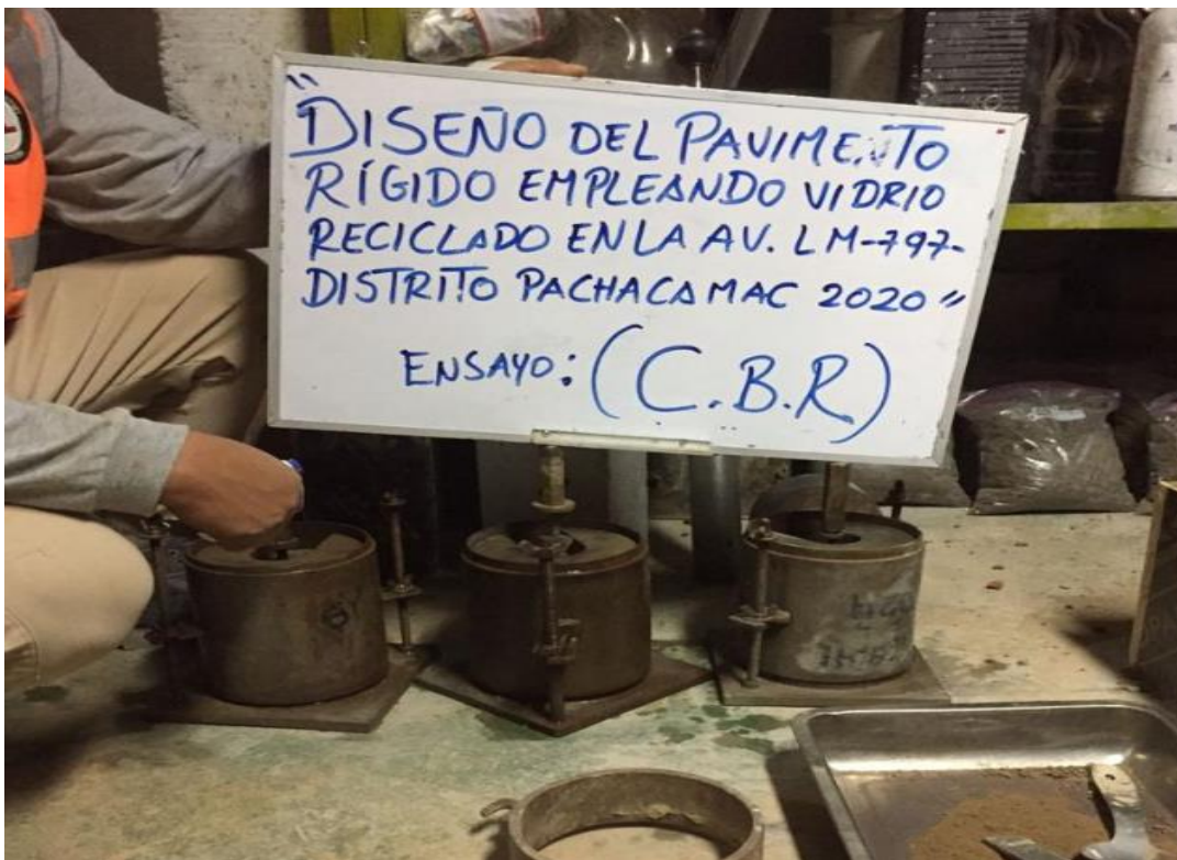
Fotografía 11. Investigador realizando ensayo de C.B.R.
