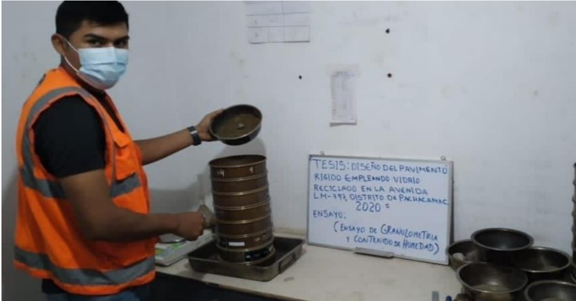
Fotografía 8. Investigador realizando ensayo de granulometría.
