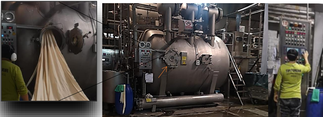
Figura N° 22: colocar la tela en el overflow
