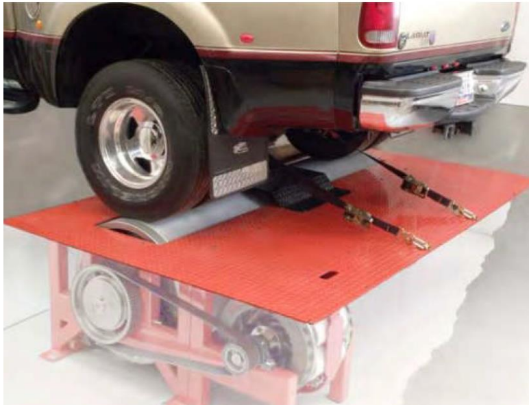
Figura 5. Banco de rodillo con Dinamómetro de Corrientes de Foucault
