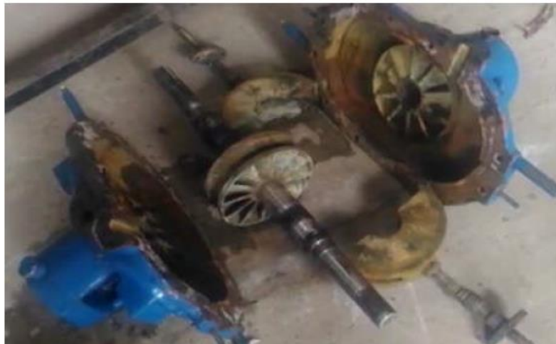
Figura 12. Dinamómetro Hidráulico, eje central y alabes laterales
