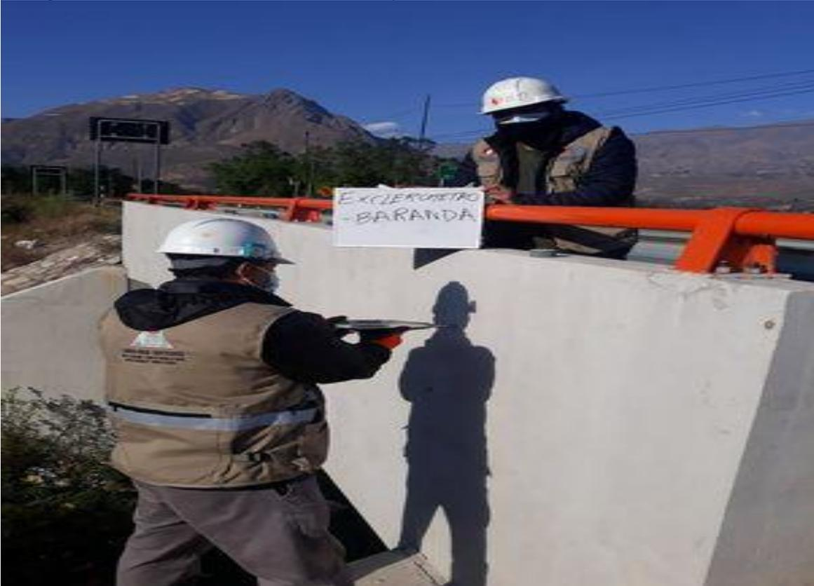
Ensayo de esclerómetro en muro pantalla I
