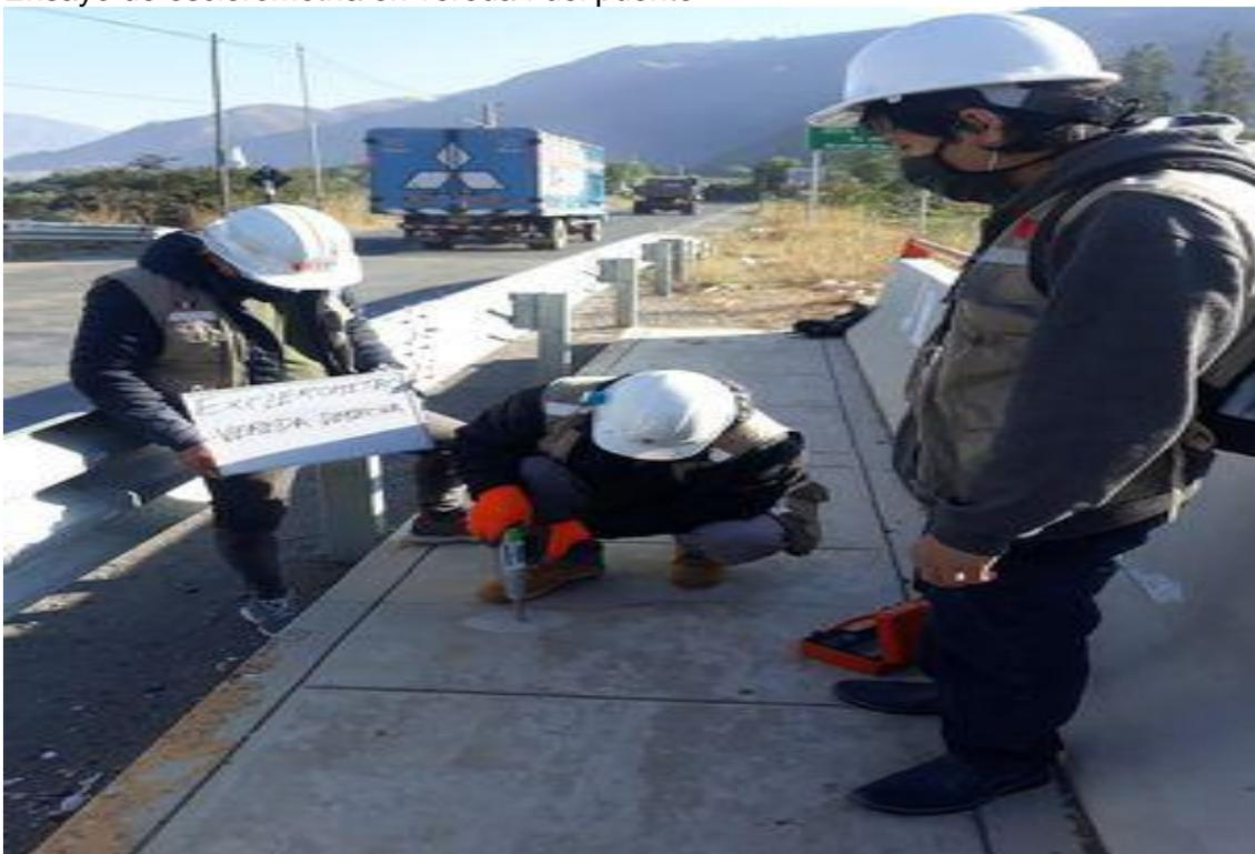
Ensayo de esclerómetro tablero del puente
