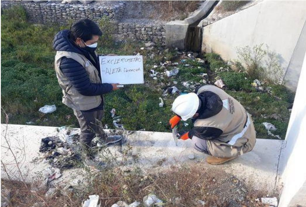
Ensayo de esclerometría en vereda I del puente
