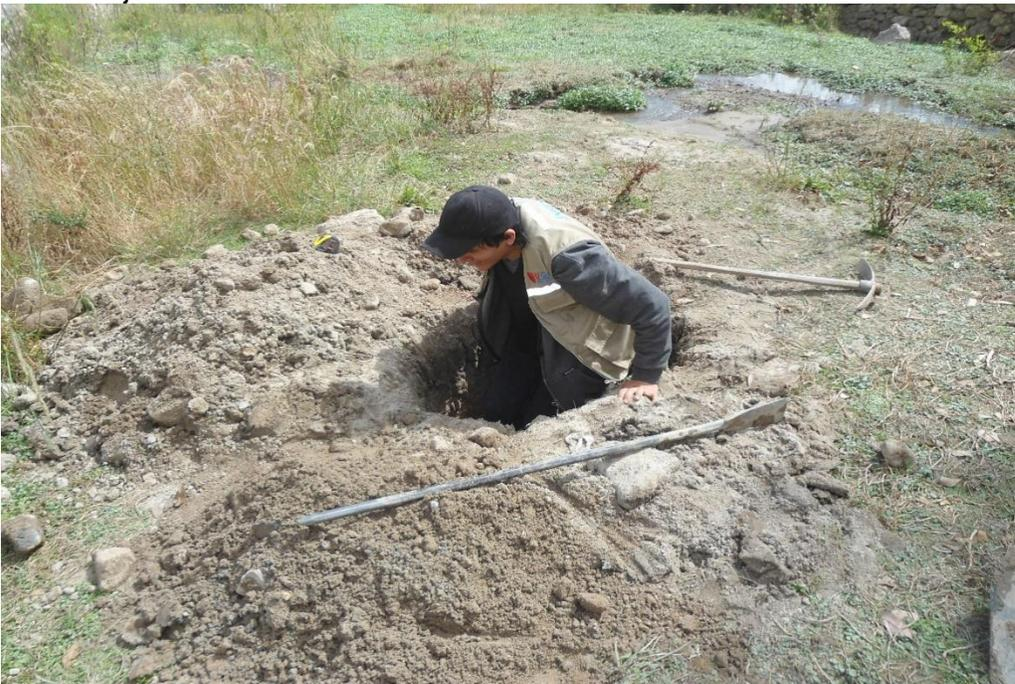
Fotografía 12: Toma de muestra se realizó una calicata de 1.50m y de un alcance de 1m<sup>2</sup> para definir los ensayos de laboratorio correspondiente al ensayo de capacidad admisible en pilares.
