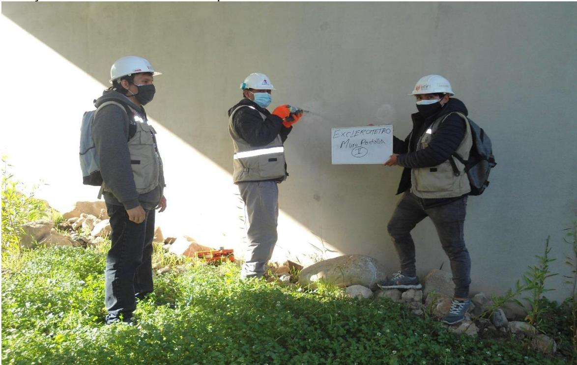
Ensayo de esclerómetro en muro pantalla II
