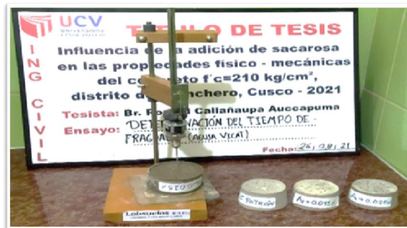
Figura 24. Verificación del tiempo de fraguado
