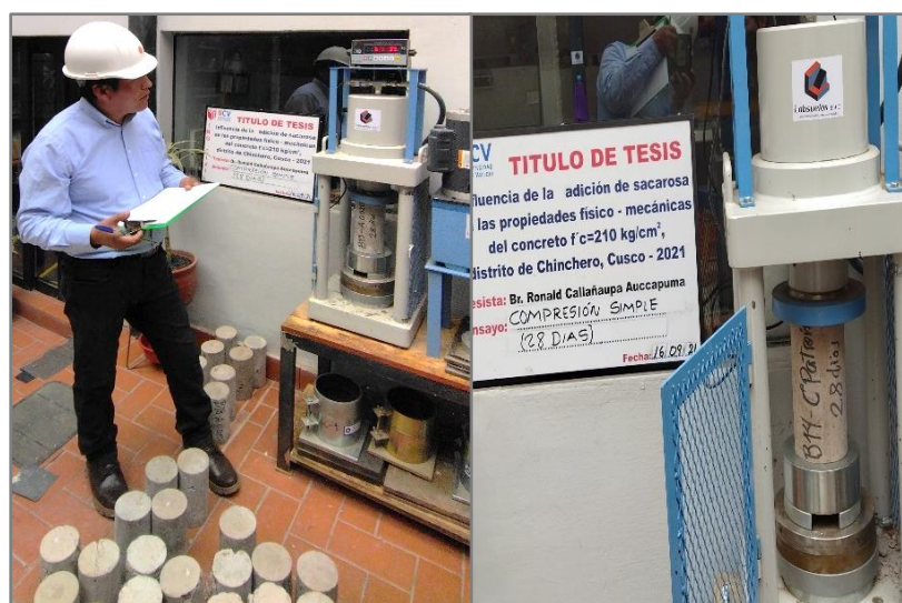
Figura 34. Ensayo de resistencia a la compresión a los 28 días
