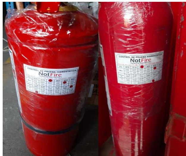
Figura 56. Extintores con prueba hidrostática
