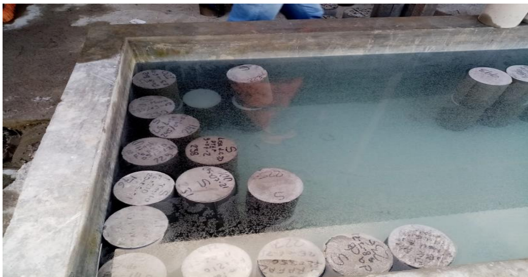
Ilustración 15.-Especímenes en proceso de curado. Cumplido los 28 días fueron sometidos al ensayo de resistencia a la compresión.
