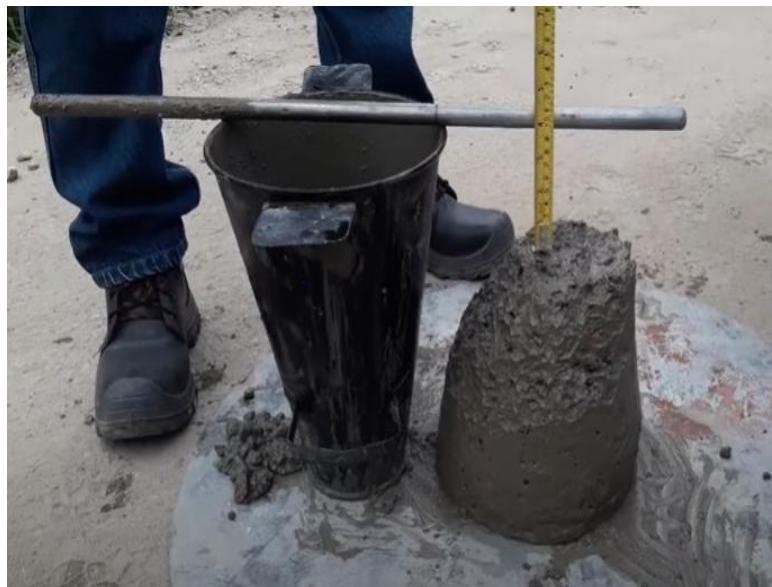
Ilustración 2 : Asentamiento en concreto Patrón
