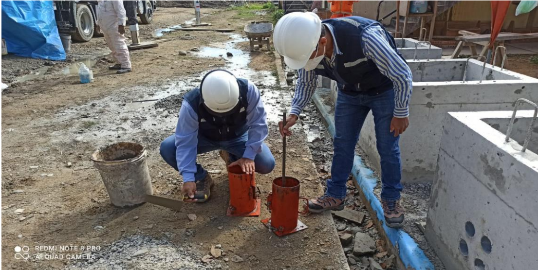
Ilustración 13.- Elaboración de testigos
