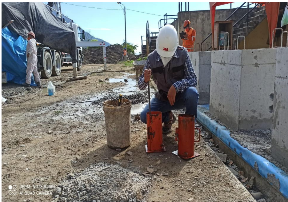
Ilustración 12.- Elaboración de testigos
