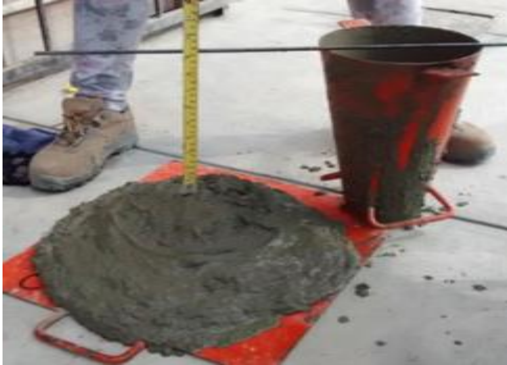
Ilustración 14.- Ensayo Slump, concreto con 1000ml de aditivo superplastificante.
