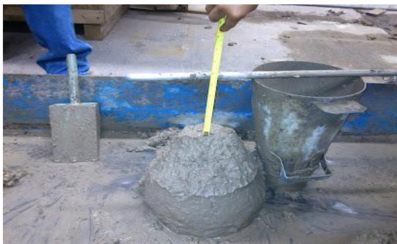
Ilustración 4 Asentamiento con adición de 500 ml de superplastificante
