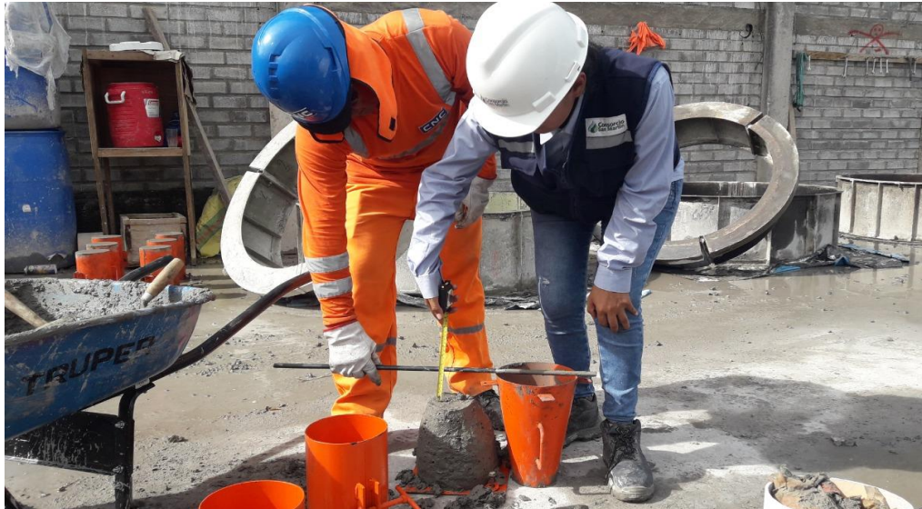
Ilustración 11.- Slump en concreto Patrón
