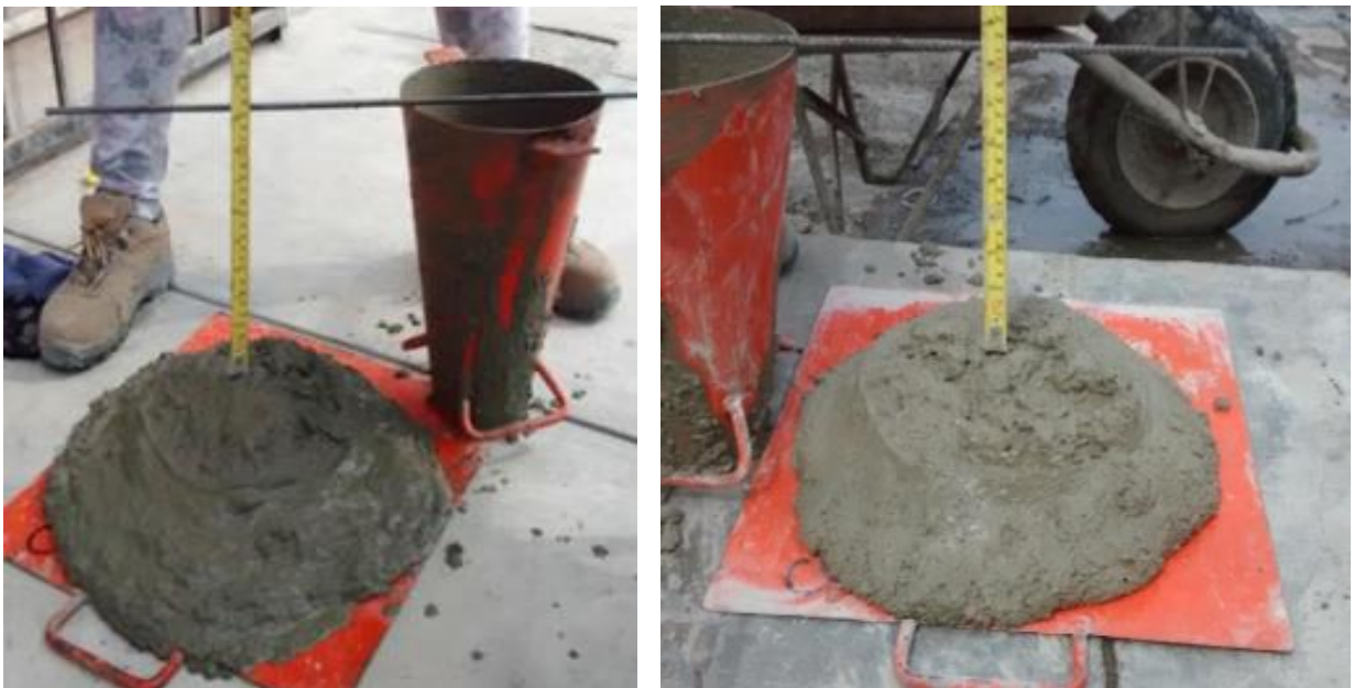
Ilustración 5 : Asentamiento con adición de 1000 ml de superplastificante
