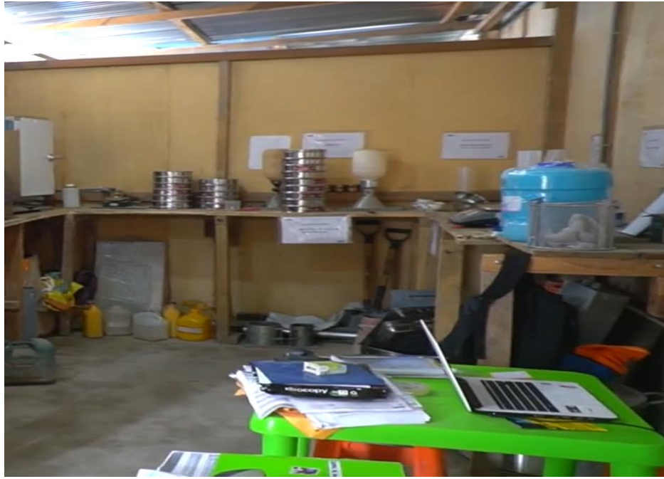
Ilustración 9.-Algunos de los equipos utilizados para los ensayos de contenido de humedad de los agregados.
