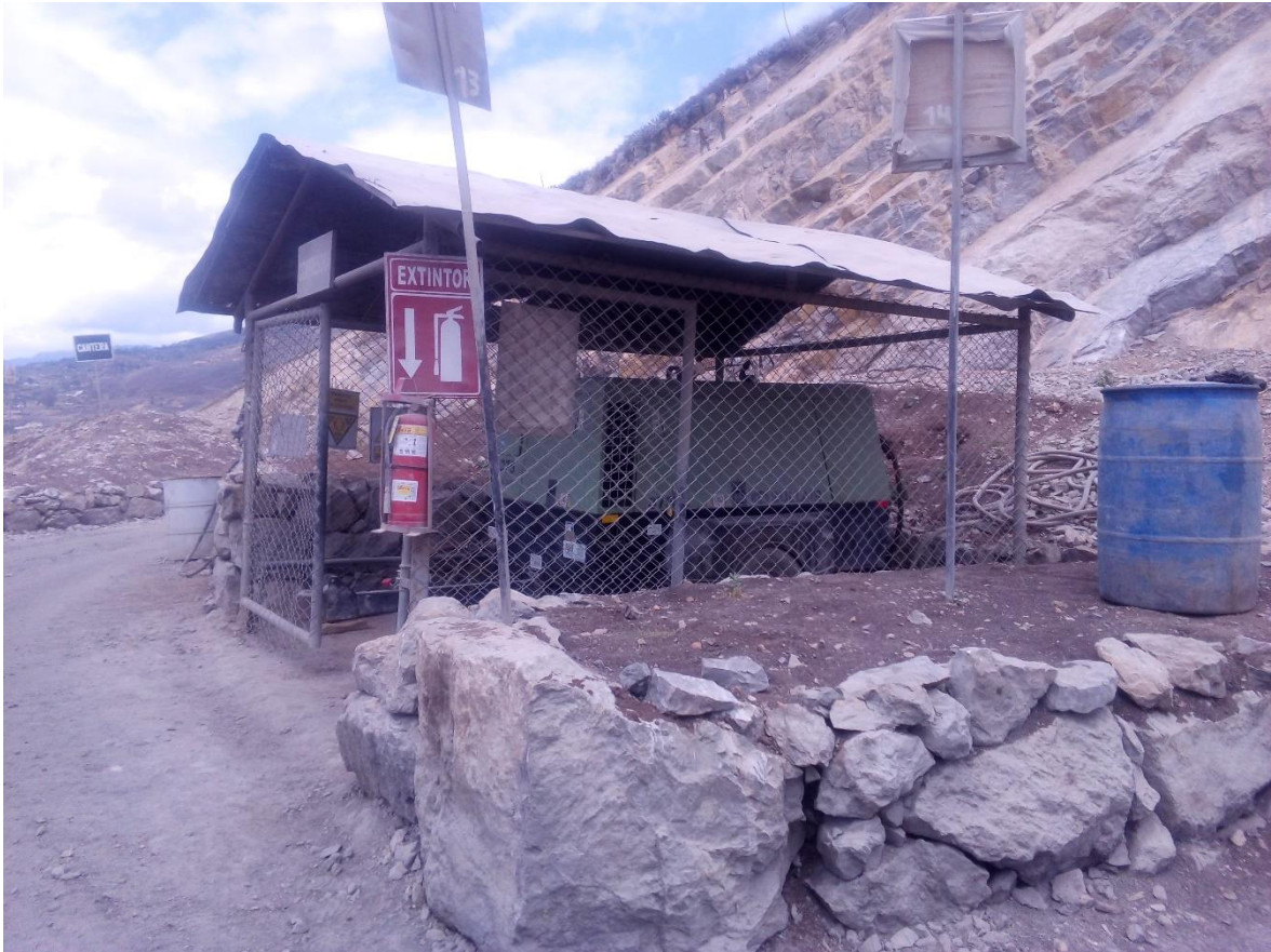
Figura 6: Máquina compresora que se utiliza para la perforación. Fuente: Fotografía tomada insito calera bendición de Dios.
