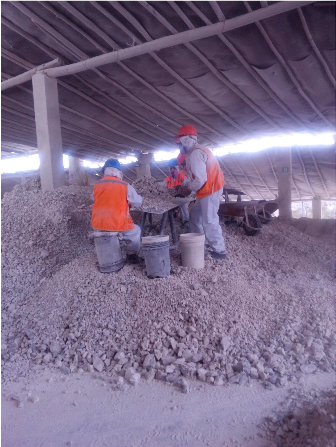
Figura 10: Selección de cal después de la calcinación. Fuente: Fotografía tomada insito calera bendición de Dios.
