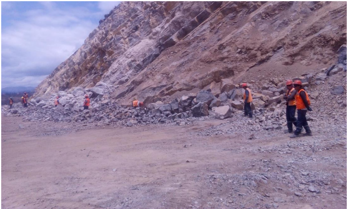
Figura 7: Personal haciendo la selección de piedra después de la voladura. Fuente: Fotografía tomada insito calera bendición de Dios.
