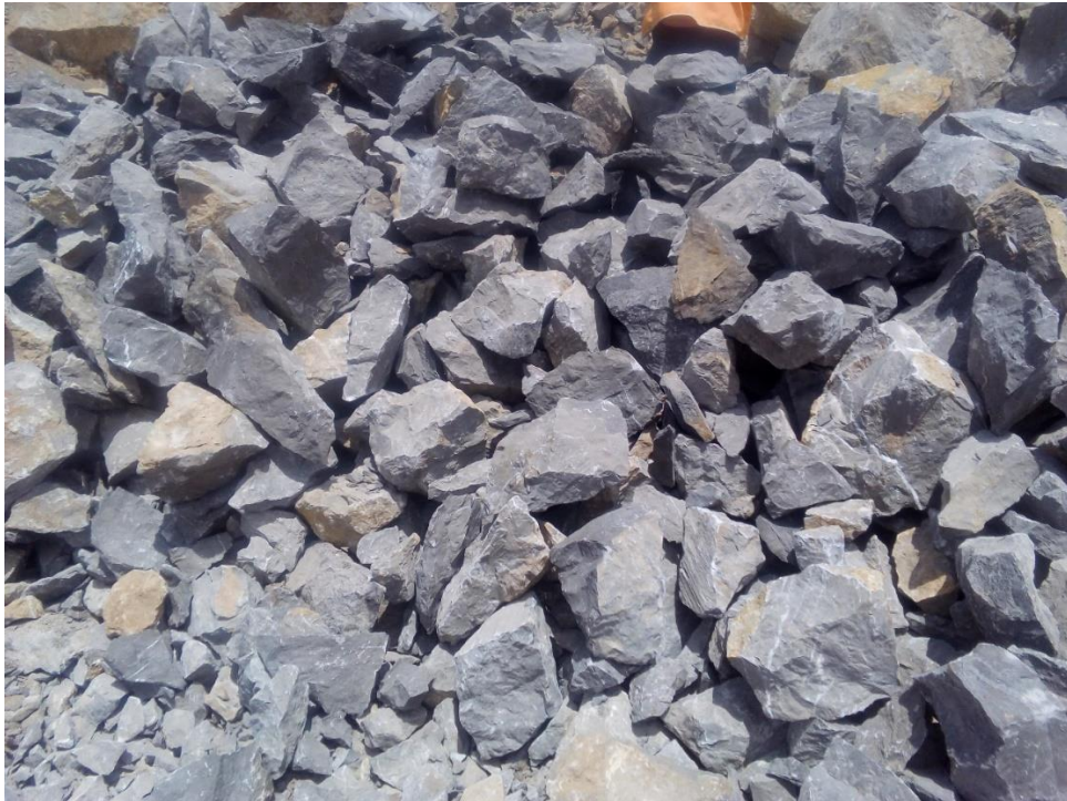
Figura 9: Piedra seleccionada de 2" a 4" para la calcinación. Fuente: Fotografía tomada ínsito calera bendición de Dios.
