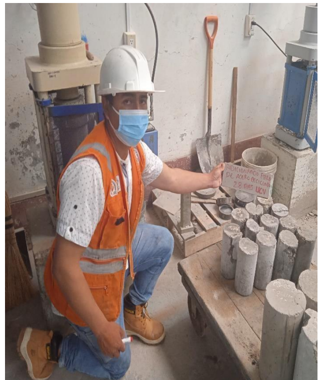
Ensayos de compresión de especímenes cilíndricas a la edad de 7, 14 y 28 días, Concreto con fibras al 0 kg/m 3 , 30 kg/m 3 , 45 kg/m 3 y 60kg/m 3 . Fuente: elaboración propia (2021).
