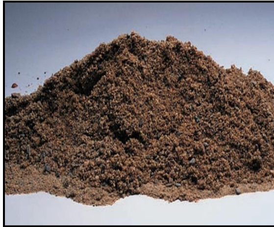
Figura 17. Agregado fino para la preparación de mezclas de concreto
