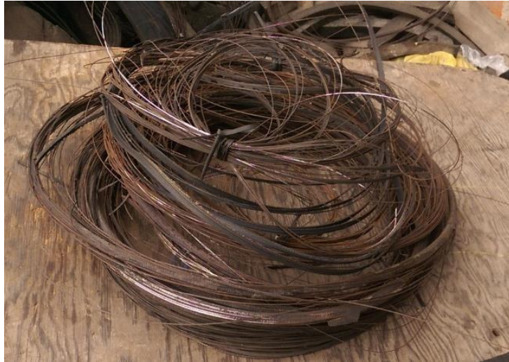
Figura 16. Grupo de fibras de acero removidas de los bordes interiores.
