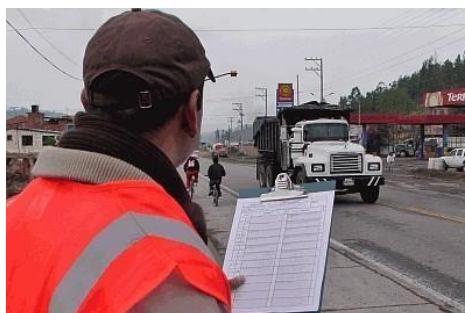
Figura 23. Estudio del impacto vehicular en las cargas transmitidas al pavimento rígido. Fuente: Elaboración Propia, (2021)
