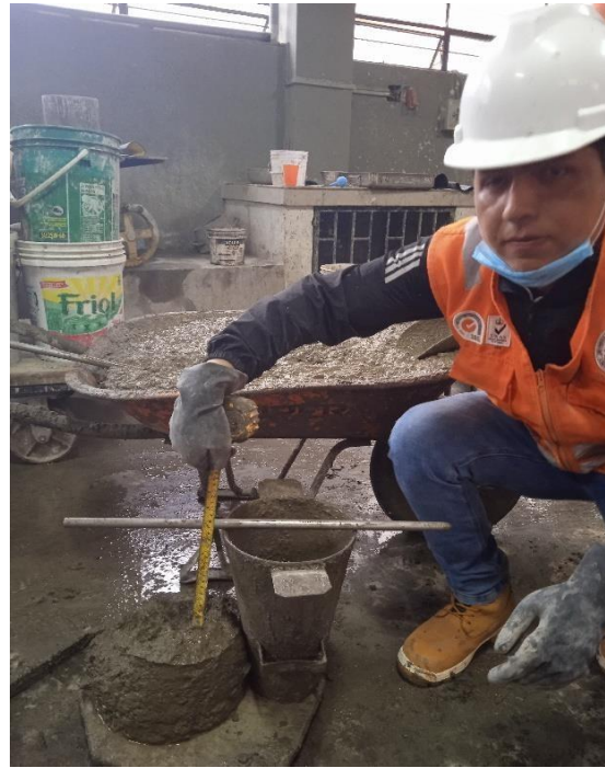
Ensayo de cono de Abraham. Fuente propia (2021)
