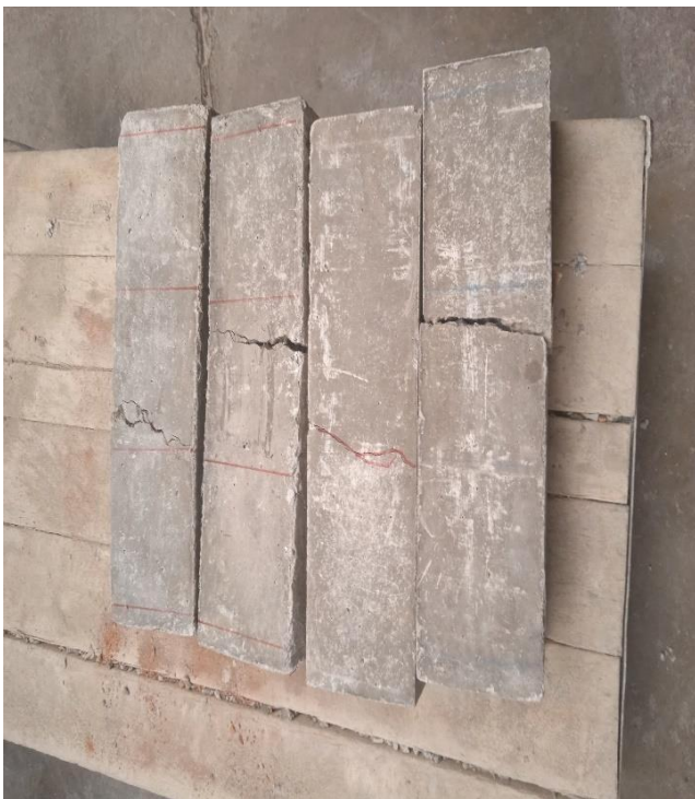
Ensayos de flexión de vigas a la edad de 7, 14 y 28 días, Concreto con fibras al 0 kg/m 3 , 30 kg/m 3 , 45 kg/m 3 y 60kg/m 3 . Fuente: elaboración propia (2021).
