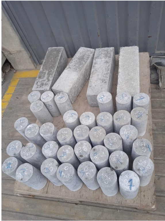
Curado de especímenes. Fuente: elaboración propia (2021)
