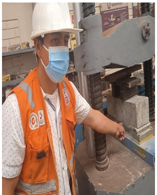
Ensayos de flexión de vigas a la edad de 7, 14 y 28 días, Concreto con fibras al 0 kg/m 3 , 30 kg/m 3 , 45 kg/m 3 y 60kg/m 3 . Fuente: elaboración propia (2021).
