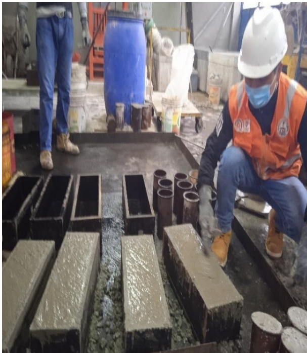
Fabricación de viga 50x15x15. Fuente: elaboración propia (2021)
