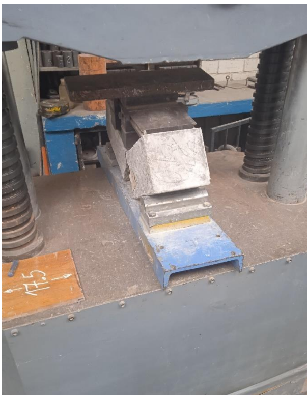
Ensayos de flexión de vigas a la edad de 7, 14 y 28 días, Concreto con fibras al 0 kg/m 3 , 30 kg/m 3 , 45 kg/m 3 y 60kg/m 3 . Fuente: elaboración propia (2021).
