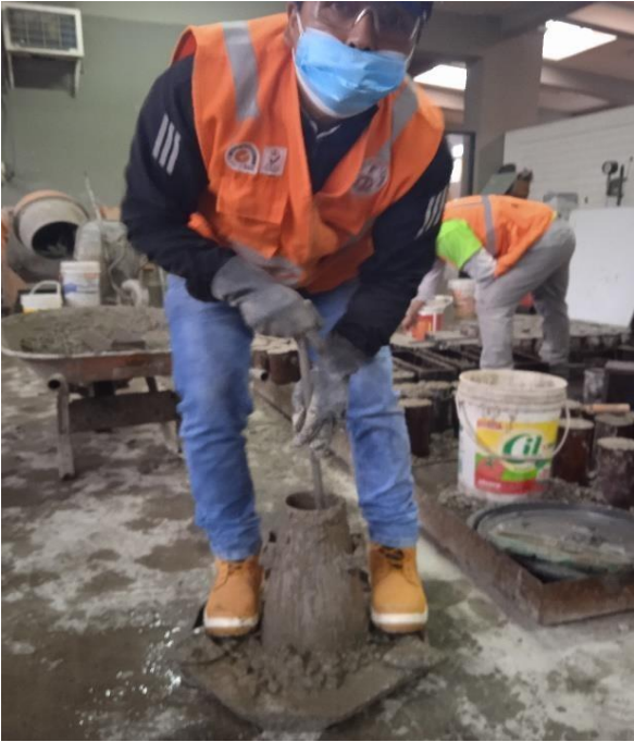
Ensayo de cono de Abraham. Fuente propia (2021)
