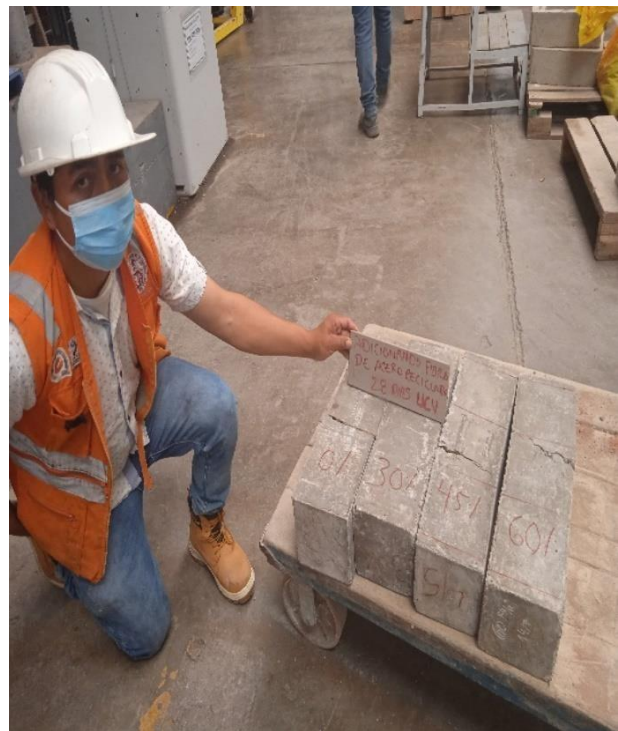
Ensayos de flexión de vigas a la edad de 7, 14 y 28 días, Concreto con fibras al 0 kg/m 3 , 30 kg/m 3 , 45 kg/m 3 y 60kg/m 3 . Fuente: elaboración propia (2021).
