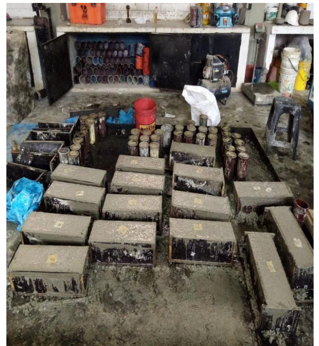
Fabricación de viga 50x15x15. Fuente: elaboración propia (2021)
