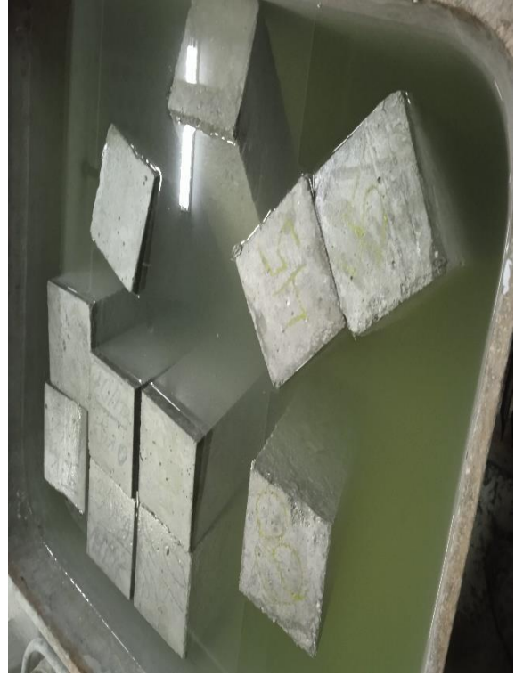
Curado de especímenes. Fuente: elaboración propia (2021)
