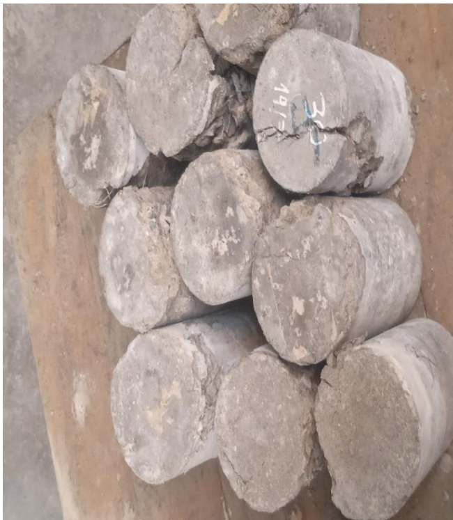
Ensayos de compresión de especímenes cilíndricas a la edad de 7, 14 y 28 días, Concreto con fibras al 0 kg/m 3 , 30 kg/m 3 , 45 kg/m 3 y 60kg/m 3 . Fuente: elaboración propia (2021).
