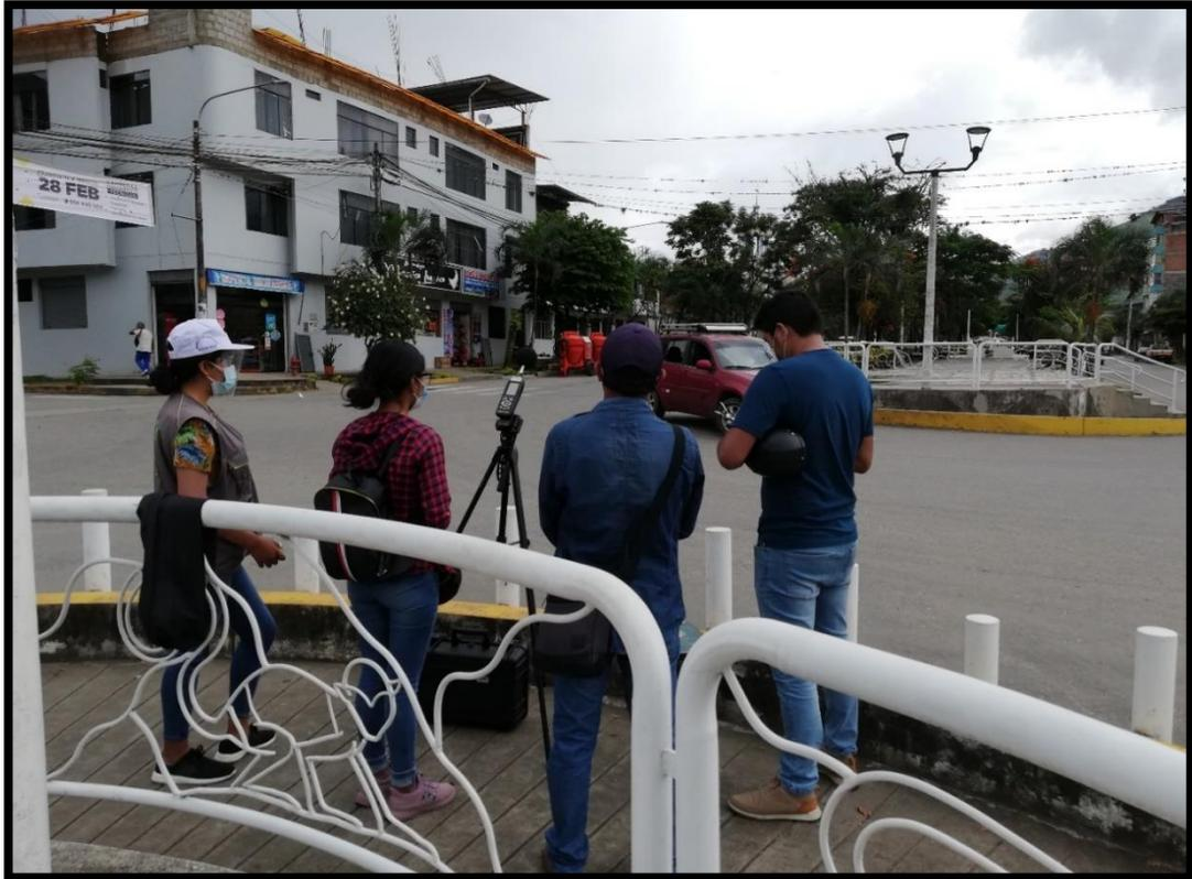
**Figura 3.** *Instalación de sonómetro en punto de monitoreo.*
