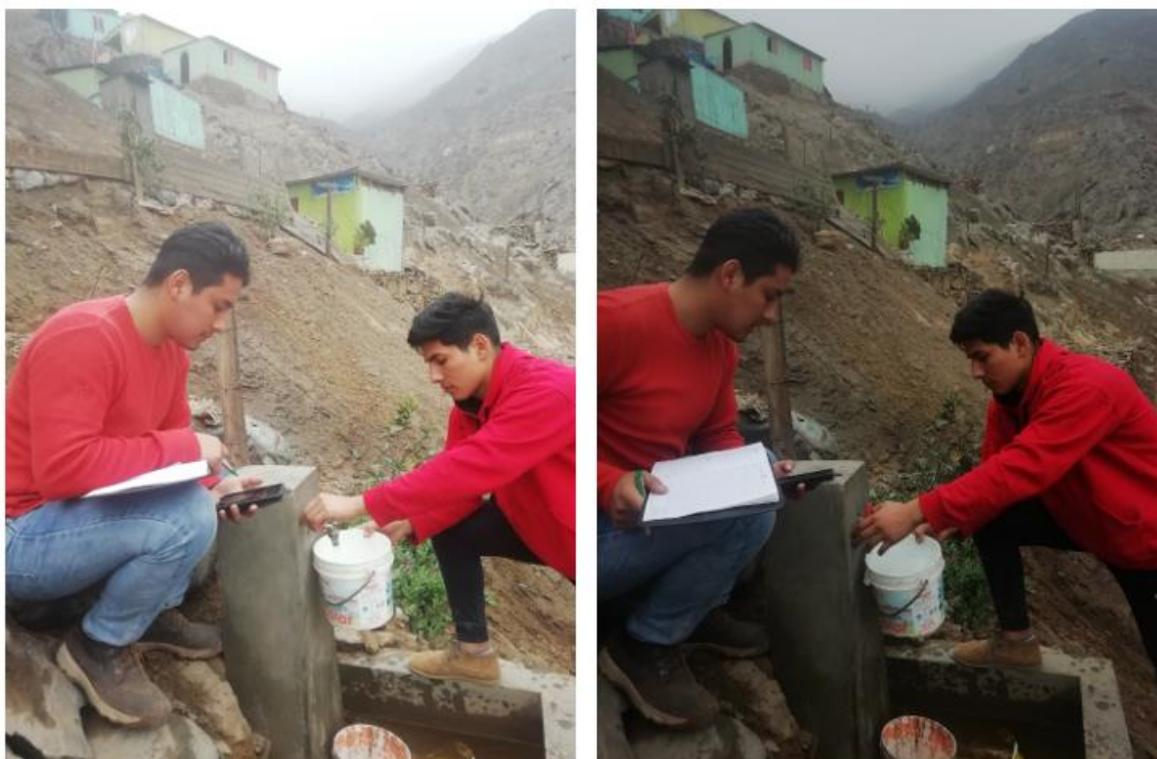
*figura 18. Aforo volumétrico*
