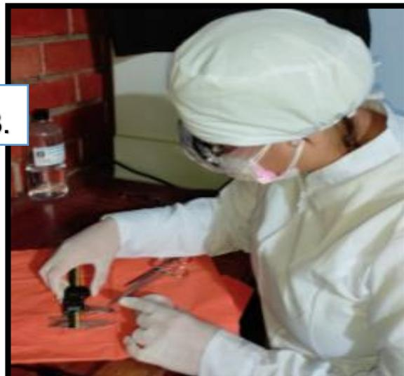
11. Platina con base de acrílico transparente con los pines metálicos.
