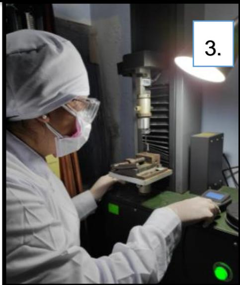
1. Máquina de Ensayos Universal marca LG® modelo CMT 5L
