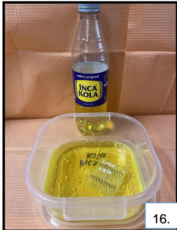
14. Soluciones de inmersión compuestas por bebidas carbonatadas y el agua destilada utilizada para nuestro grupo control.
