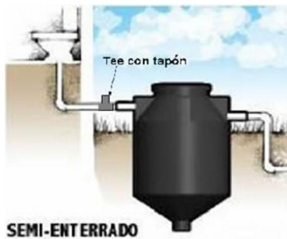
Cuando el biodigestor trabaja semi-enterrado la tee cumplirá la función de registro. Registro Roscado de bronce.
