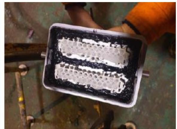
Se cambiaron nuevos conectores de 24 pines del tablero eléctrico principal el cual se dañó por falso contacto.
