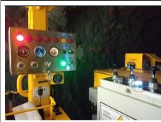
El tablero de encendido de motor indica mediante una lámpara piloto que el motor diésel tiene bajo nivel de combustible lo cual no permite movilizar la máquina.
