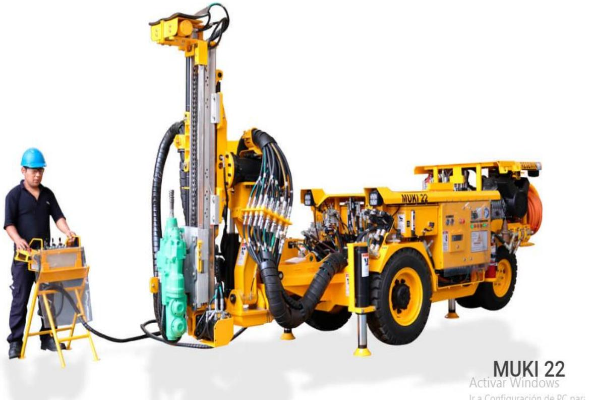
Figura 15. MUKI FF Jumbo electrohidráulico de perforación frontal en secciones angostas. Fuente: Página oficial de Resemin S.A.
