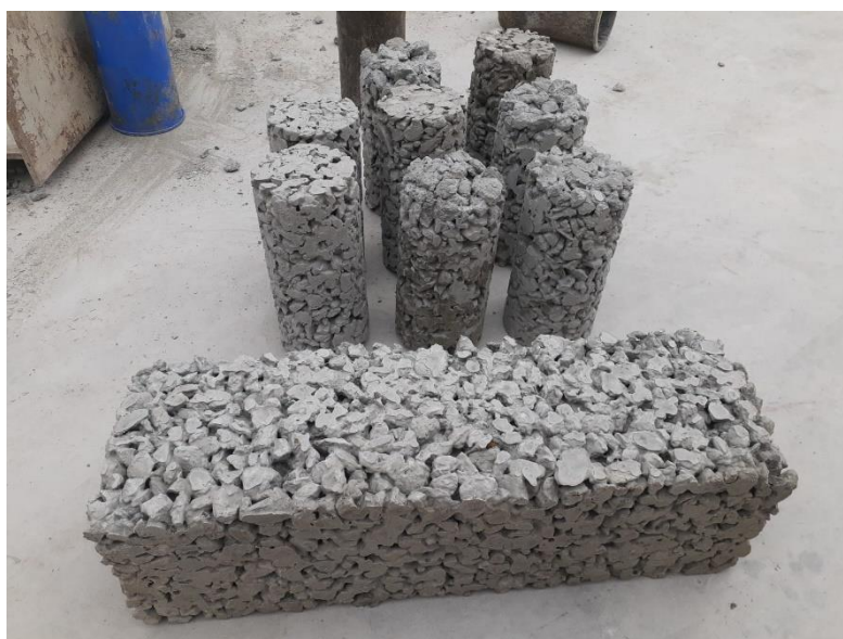
Figura 10. Testigos de mezcla de Concreto Permeable III
