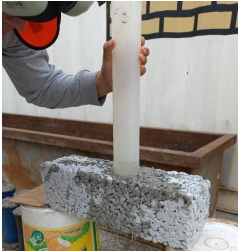
Figura 16. Ensayo de permeabilidad de mezcla de Concreto Permeable II
