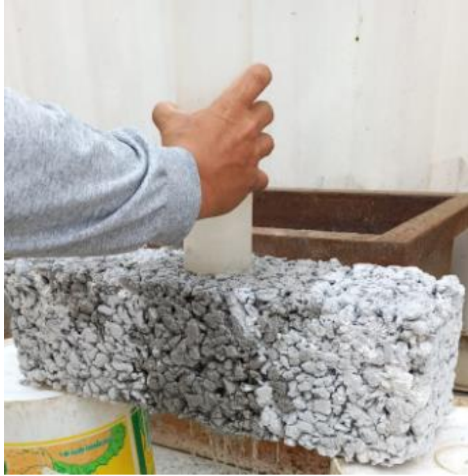
Figura 17. Ensayo de permeabilidad de mezcla de Concreto Permeable III
