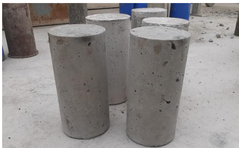
Figura 08. Testigos de mezcla de Concreto Permeable I
