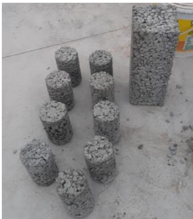
Figura 09. Testigos de mezcla de Concreto Permeable II
