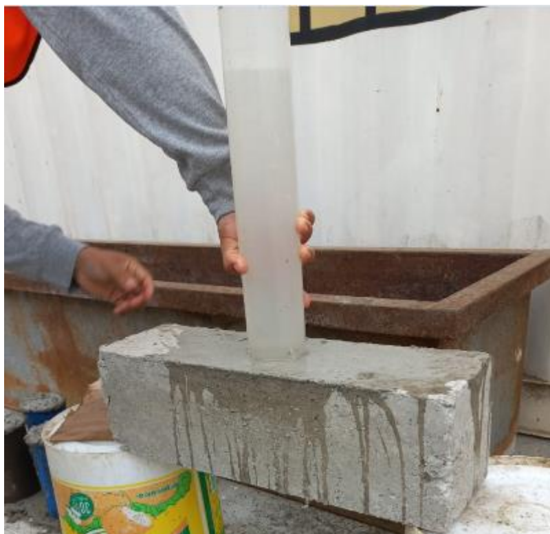
Figura 15. Ensayo de permeabilidad de mezcla de Concreto Permeable I
