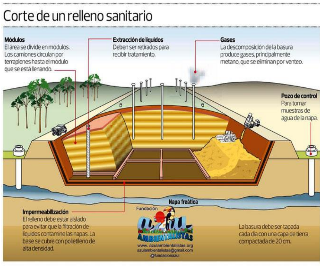
Figura 02: corte de un relleno sanitario
