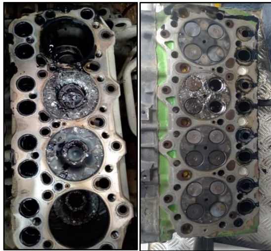
Figura 35. Antes del Mantenimiento. Elaboración Propia
