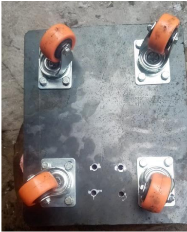
Figura 26: Construcción base móvil.
