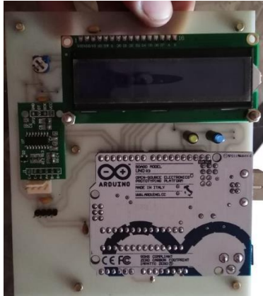
Figura 29: Ensamble de arduino y pantalla LCD.
