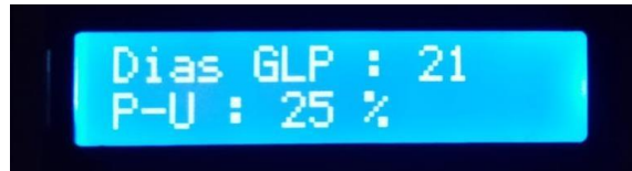
Figura 6: Pantalla LCD mostrando 16x2 caracteres.
