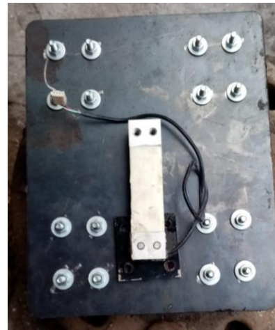
Figura 27: Ensamble celda de carga con plancha.
