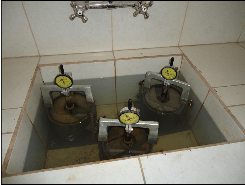
Foto 10: Saturado de muestras para hallar el CBR
