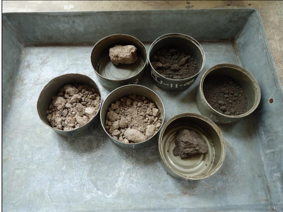
Foto 12: Muestras extraídas del horno para determinar el contenido de humedad óptimo.
