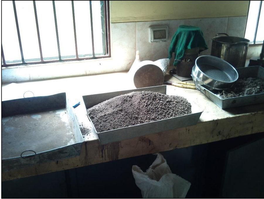
Foto 08: Vista de material combinado con cca + cal..
