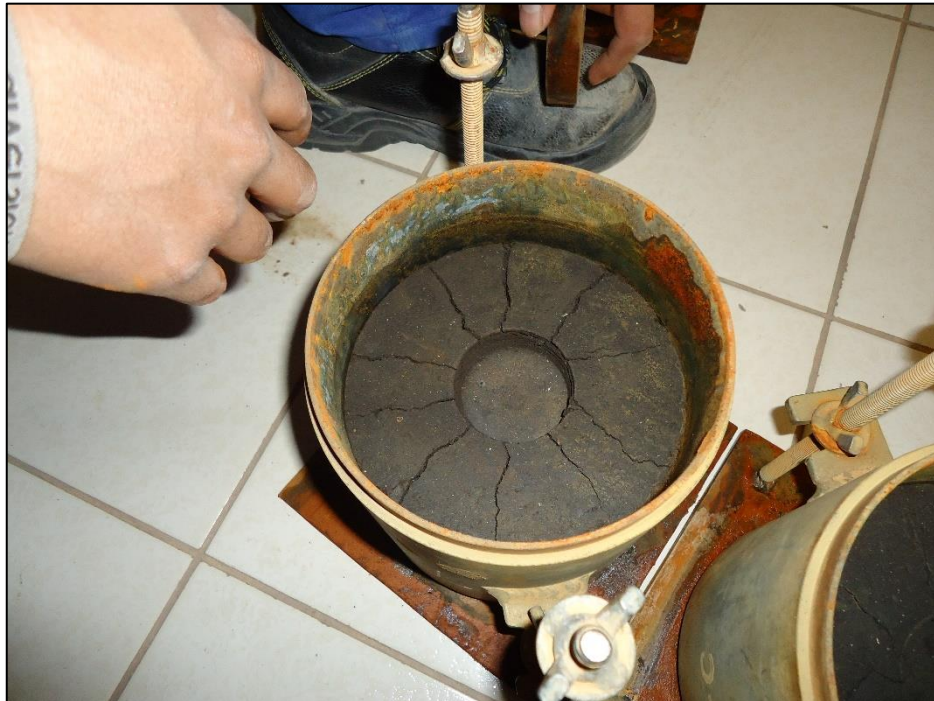
Foto 09: Fisurado de muestra después del apisonado
