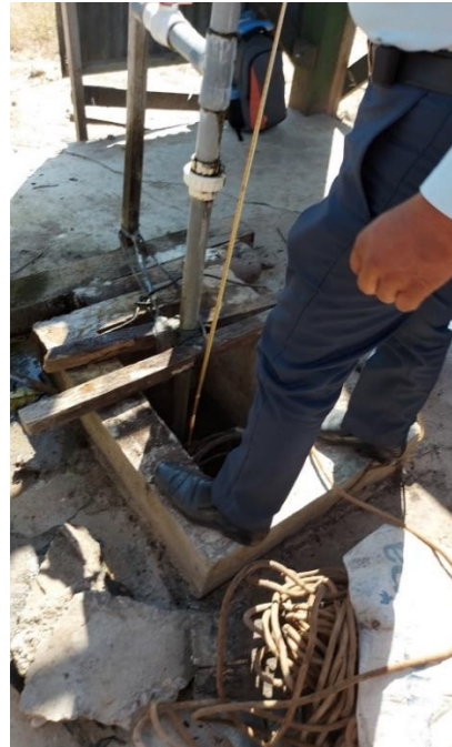
Toma de datos de la altura dinámica del nivel freático. El cual es igual a 9.43 m.
