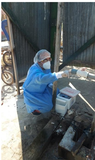
Se observa la limpieza y desinfección del punto de muestreo, ubicado en la salida del pozo tubular.
