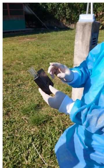
Observamos la utilización del kit de cloro libre tipo disco HACH CN-66F, en la medición del cloro residual en el agua ubicado en la pileta del local comunal. El cual dio resultado 0 Mg/L.
