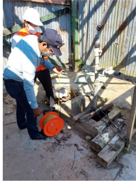
Colocación del pozómetro en el tubo del pozo tubular; el cual tiene 80 m aprox.
