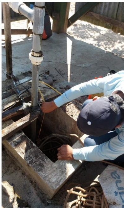
Toma de la altura estática del nivel freático. El cual es igual a 3.76 m.
