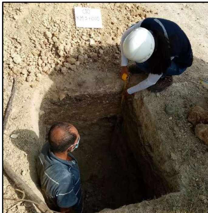
Figura 19: Las Guineas- Mañumal, Excavación de Calicata 10 (km. 5+000), por extracción de muestra de suelo, evidencia fotográfica, 2021.
