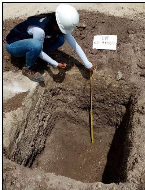
Figura 18: Las Guineas- Mañumal, Excavación de Calicata 8 (km. 4+000), por extracción de muestra de suelo, evidencia fotográfica, 2021.
