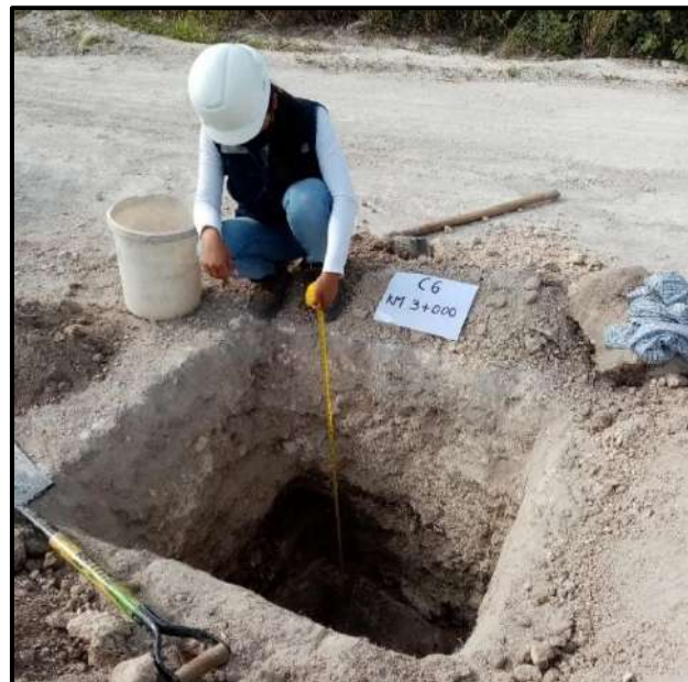
Figura 16: Las Guineas- Mañumal, Excavación de Calicata 6 (km. 3+000), por extracción de muestra de suelo, evidencia fotográfica, 2021.
