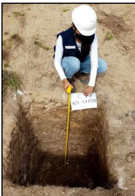
Figura 14: Las Guineas- Mañumal, Excavación de Calicata 4 (km. 2+000), por extracción de muestra de suelo, evidencia fotográfica, 2021.
