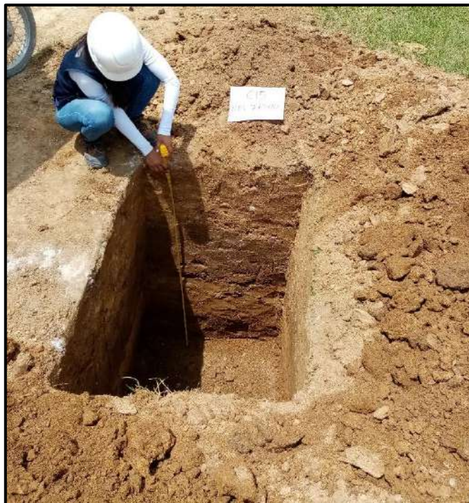
Figura 24: Las Guineas- Mañumal, Excavación de Calicata 14 (km. 7+000), por extracción de muestra de suelo, evidencia fotográfica, 2021.
