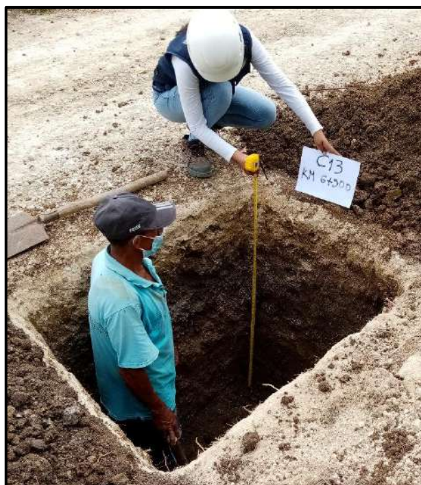
Figura 22: Las Guineas- Mañumal, Excavación de Calicata 13 (km. 6+500), por extracción de muestra de suelo, evidencia fotográfica, 2021.
