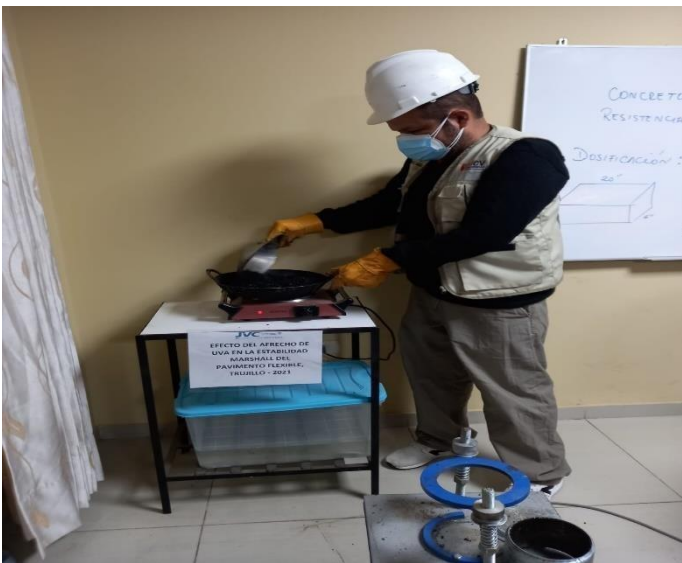
FOTO 15: Calentado la mezcla patrón más el aditivo para llegar a su temperatura optima.
