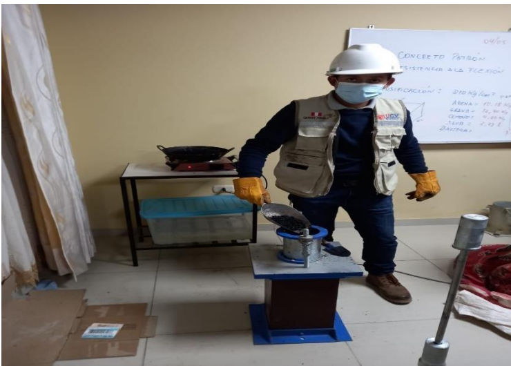
FOTO 11: Vaciado de asfalto en molde de briquetas (El molde tiene un diámetro interior de 4" (101,6 mm) y una altura aproximadamente 3" (76 mm). La base y el collar están diseñados para intercambiarse ya sea a uno u otro lado del molde.
