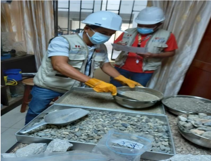
FOTO 04: Verificando los materiales (agregados) y tomando datos de estos, también Accesorios como cucharas, espátula, mezclador mecánico, baño de agua hirviendo,
