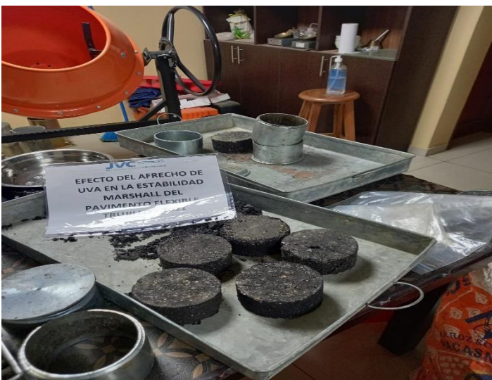
foto 18: obtención de las diferentes briquetas en laboratorio.
