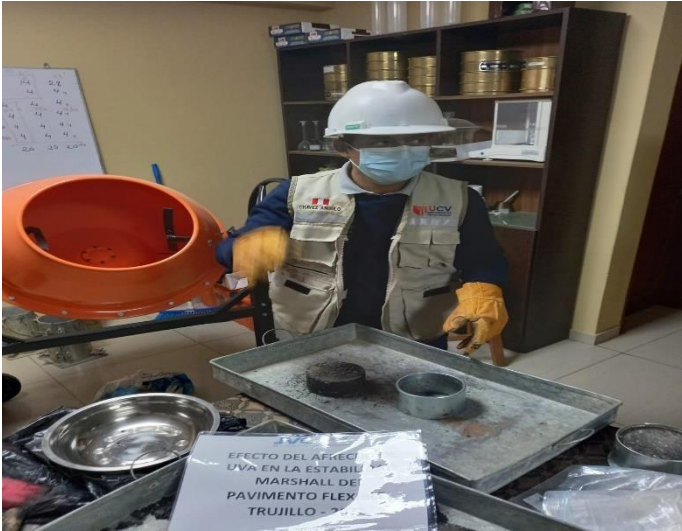
FOTO13: Briqueta de muestra patrón sin molde y lista para sus diferentes pruebas
