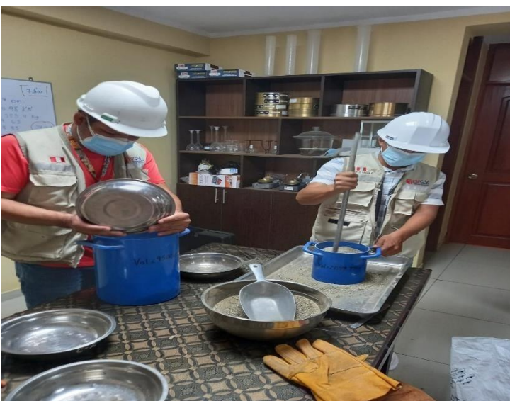
foto 09: proceso de compactación de agregados.
