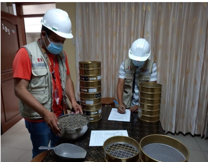
FOTO 06: Preparando los materiales a evaluar, para su tamizado.
