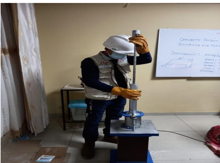
FOTO 12: Briqueta sometida al martillo de compactación Marshall. (Martillo de compactación, que consta de una barra achatada que cae deslizándose sobre una guía y un pisón de cara circular de 3 7/8" (98,4 mm). La barra pesa 10 libras (4,5 kg) y tiene una
