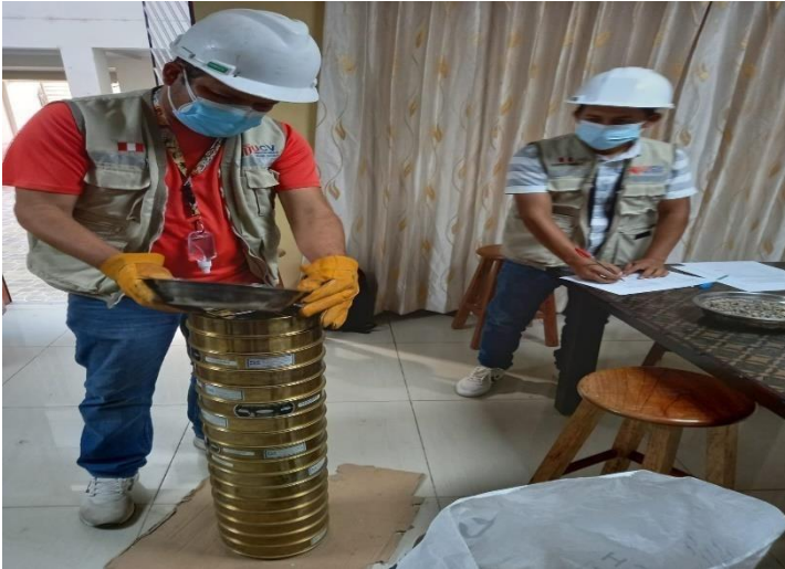
FOTO 07: Llevamos el procedimiento de tamizado a los materiales y la recolección de datos.
