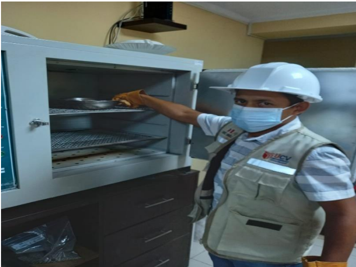
FOTO 08: Llevamos los materiales al horno, requisito para hallar contenido de humedad de agregados finos y gruesos (Horno y placa calentadora eléctrica, para calentar los materiales, Horno aireador para el curado de las mezclas.)
