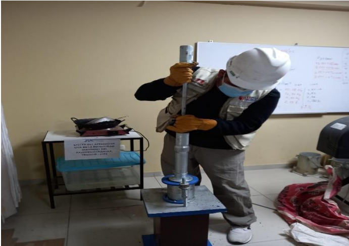
FOTO 16: Sometiendo la briqueta (mezcla patrón más aditivo) al martillo de compactación Marshall
