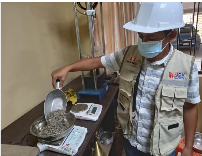
FOTO 05: Pesando los materiales (Balanza de 5 kg con aproximación a 1 g)
