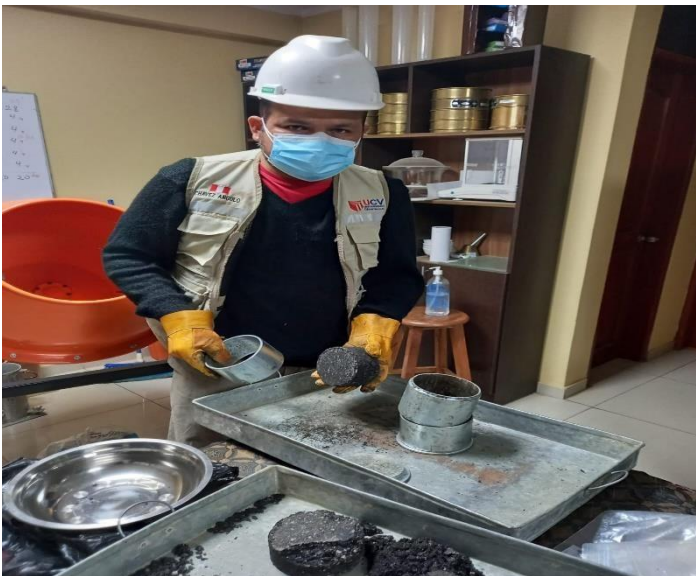
FOTO 17: Obteniendo la briqueta (mezcla patrón más aditivo) para sus respectivas pruebas.
