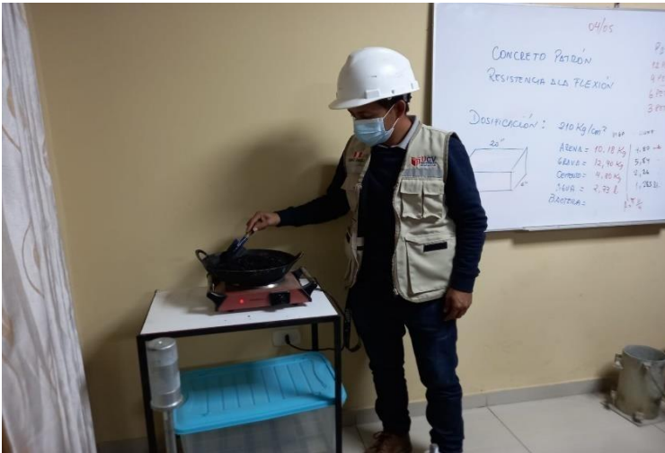
FOTO 10: Proceso de preparación de mezcla asfáltica más los agregados de mezcla patrón.
